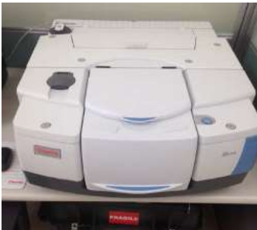
圖 1-6 隔熱塗料表面輻射率量測儀 圖 1-7 熱輻射量測儀 (Thermo iS50 FTIR)(日本京都电子/D&S AERD)
