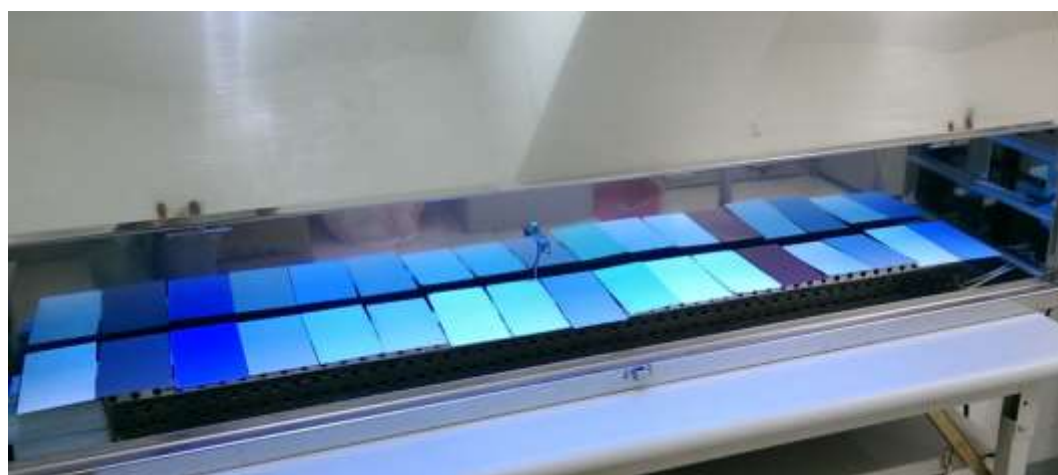
圖 4-2 將試件置入紫外線耐候試驗機
