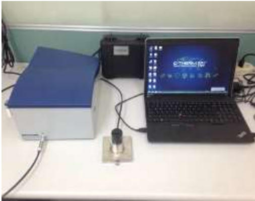
圖 1-8 熱傳導係數測儀(TCi)圖 1-9 熱傳導係數測儀(Hot disk/TPS 2500) (資料來源：本研究整理)(資料來源：本研究整理)
