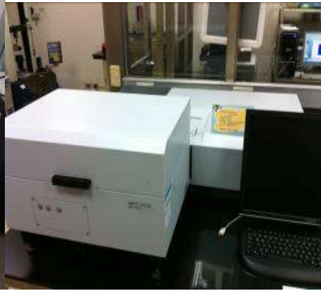
圖 1-4 隔熱漆穿透反射率光譜儀 圖 1-5 太陽光全波長光穿透反射分析 (HITACHI U4100)(Shimadzu/UV-3600)
