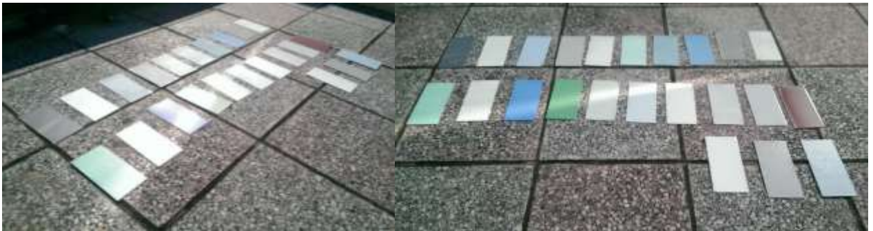
圖 4-4 自然曝曬試體擺設(鋼板) 圖 4-5 自然曝曬試體擺設(鋼板)
