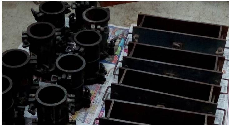
圖 3-1 抗壓試驗試體模具(左)及抗彎試驗試體模具(右)
