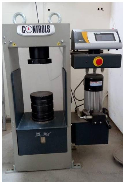
圖 3-15 抗壓試驗機
