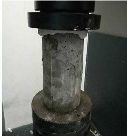
圖 3-20 混凝土抗壓強度試驗
