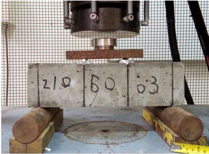
圖 3-21 混凝土抗彎強度試驗
