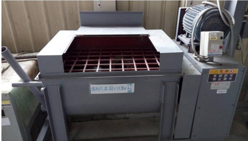
圖 3-13 強制式水平雙軸拌和機
