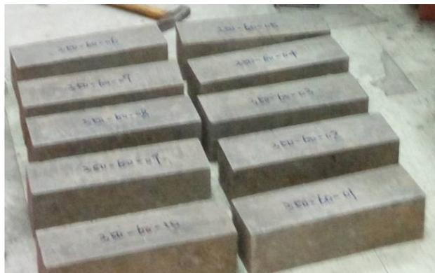
圖 3-9 抗彎試驗試體
