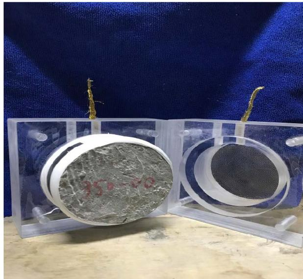
圖 3-26 壓克力材質的電位容器與銅網
