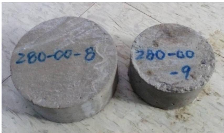
圖 3-10 滲透試驗試體(左)及氯離子滲透試驗試體(右)
