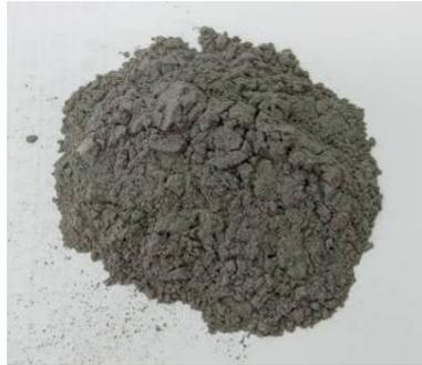
圖 3-1 台中火力發電廠所生產的 F 級飛灰
