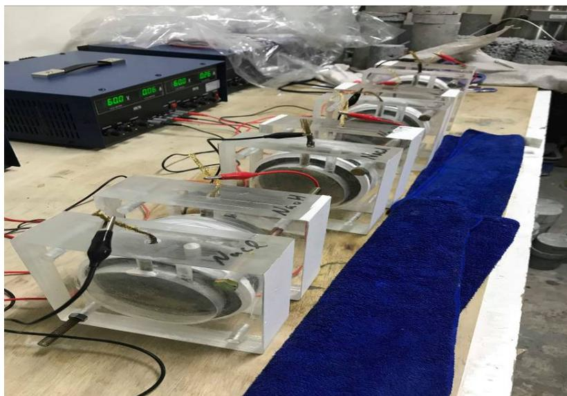
圖 3-16 快速氣離子穿透試驗儀
