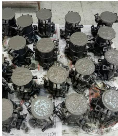
圖 3-8 抗壓試驗試體
