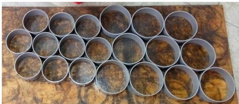
圖 3-3 氯離子滲透試驗模具(左)及滲透試驗模具(右)
