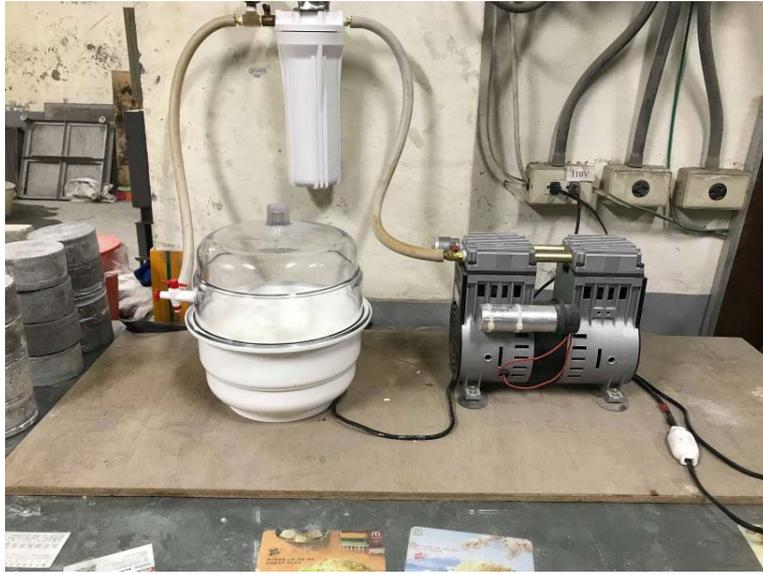
圖 3-25 RCPT 試驗抽真空幫浦容器
