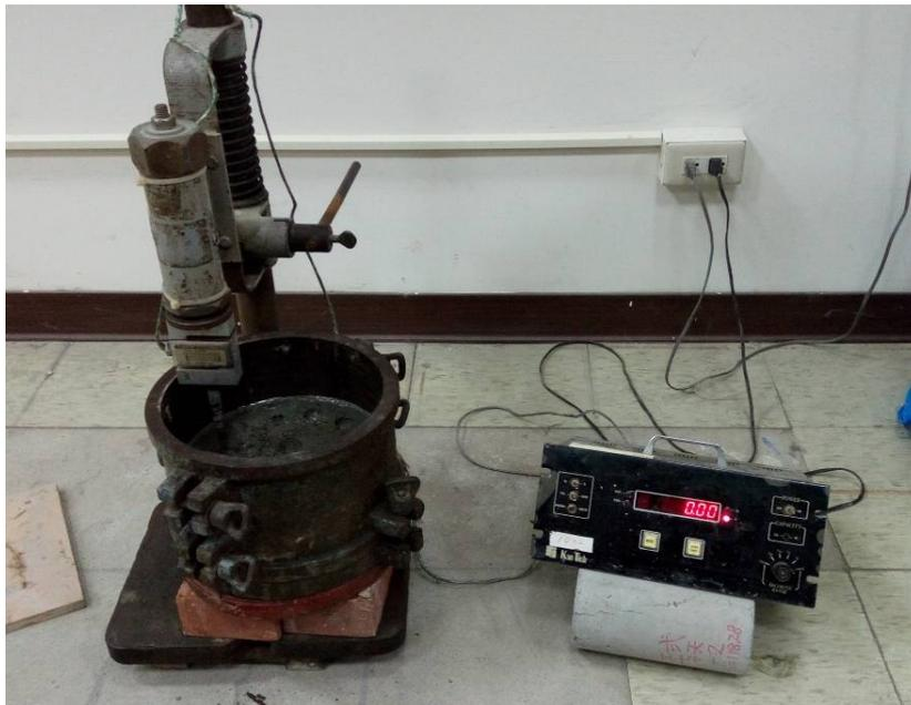
圖 3-18 混凝土初終凝試驗儀
