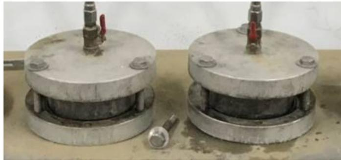
圖 3-24 混凝土滲透試驗
