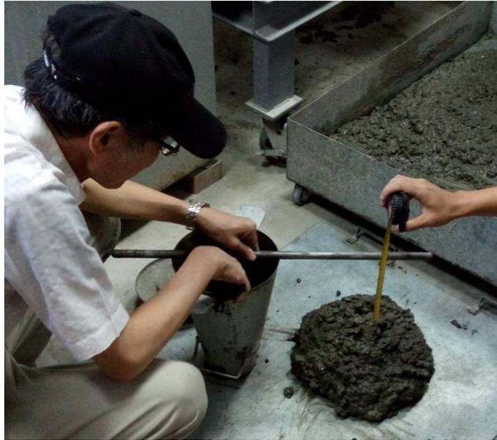
圖 3-7 混凝土坍度試驗
