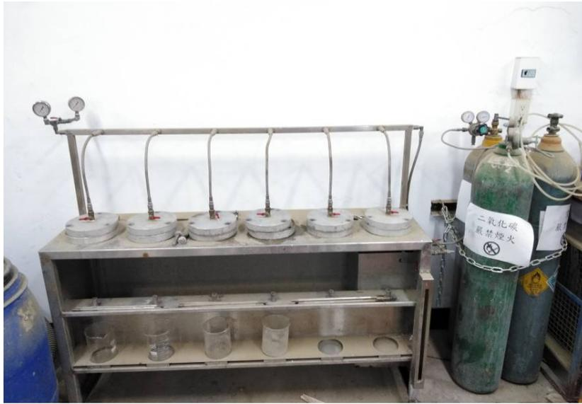
圖 3-17 透水試驗儀
