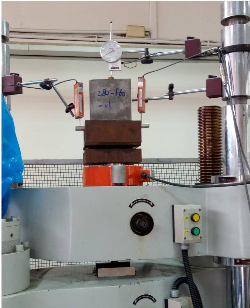
圖 3-22 鋼筋拉拔握裹試驗
