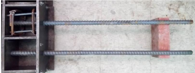
圖 3-4 鋼筋握裹試體模具
