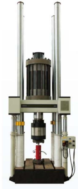
圖 3-5 250 噸動態油壓試驗機
