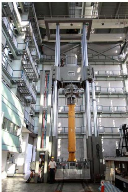
圖 3-6 3000 噸油壓試驗機
