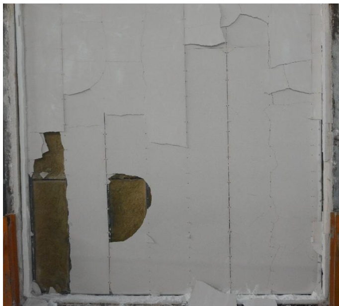
圖 5-44 實驗後曝火面內層板
