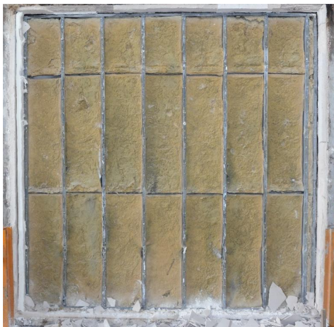
圖 5-45 實驗後曝火面岩棉
