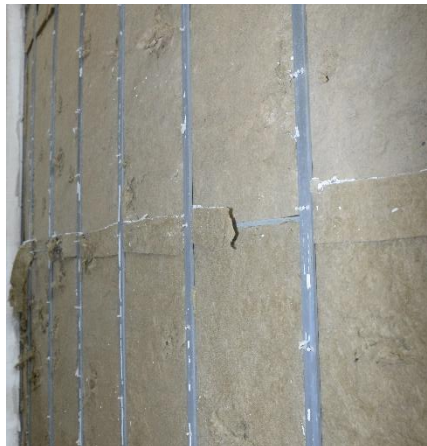
圖 5-18 實驗後曝火面岩棉
