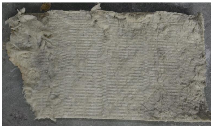
圖 5-46 實驗後非曝火面岩棉
