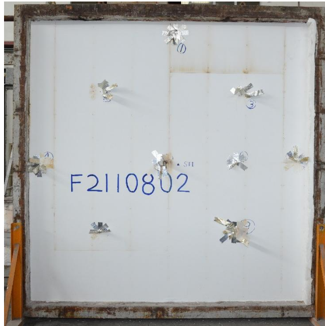
圖 5-17 實驗後試體非曝火面圖
