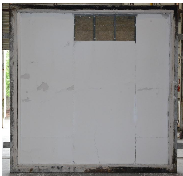
圖 5-16 實驗後試體曝火面圖
