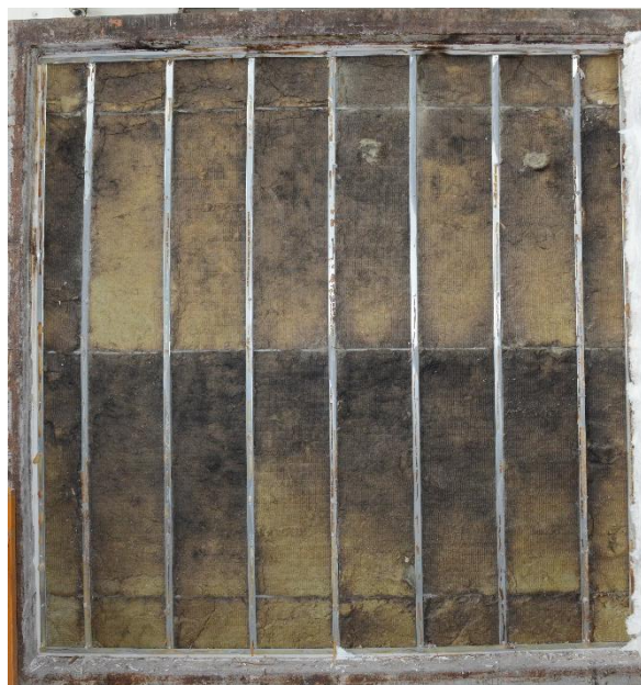
圖 5-19 實驗後非曝火面岩棉
