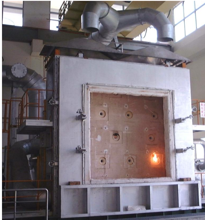
圖 3-3 門牆耐火加熱爐
