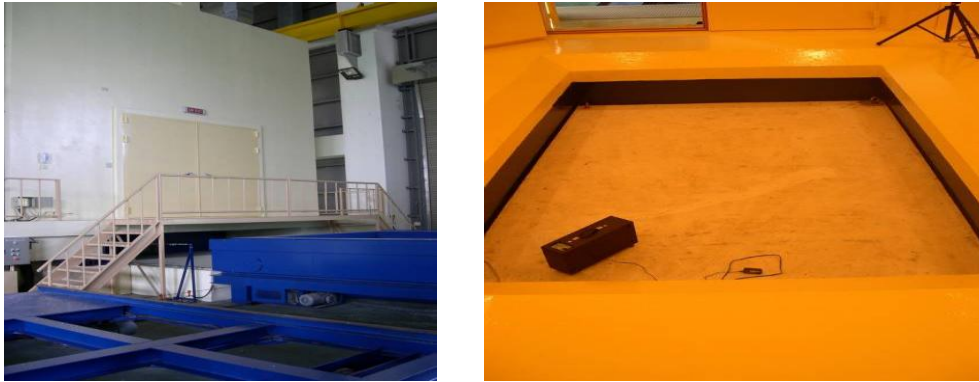
圖 B-2 樓板及表面緩衝材隔音性能檢測實驗艙
