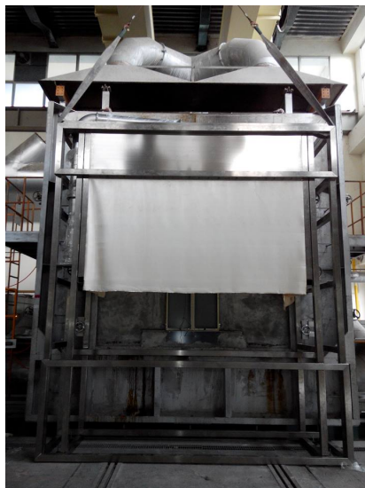
圖 6-1 CNS 11227-2 升降機乘場門耐火試驗裝置
