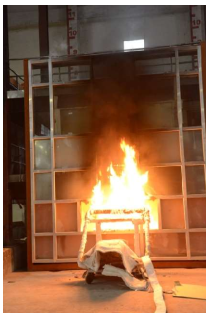
圖 6-1 CNS 11227-2 升降機乘場門耐火試驗裝置
