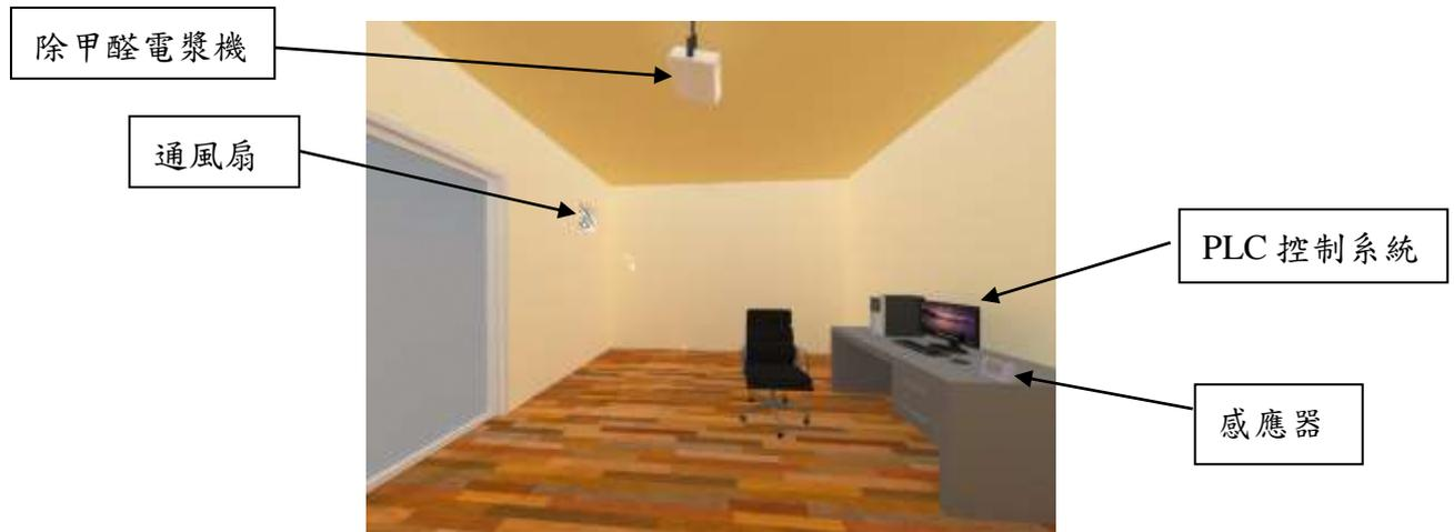
圖 2-4 PLC 監控系統室內配置圖
