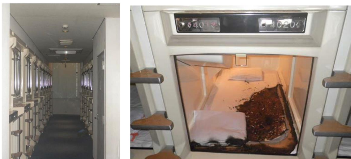
圖 2-4 住宿室內的照片及床墊燃燒的狀況
