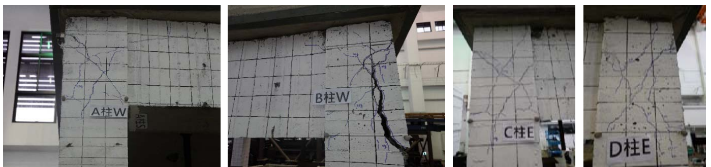
圖 25 NF 試體梁柱接頭剪力破壞 (TCU063, PGA = 0.2 g)
