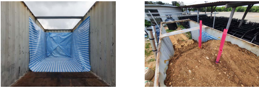
圖 2 土槽內部鋪設不透水帆布，上圖 3 大尺寸試驗模型傾斜管埋設完成 方保留 20cm 鋼板。成
