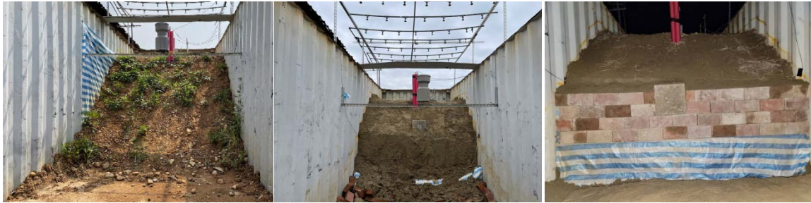
(a)未砍坡腳自然邊坡
