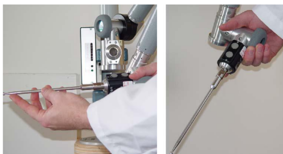
圖 2.3.3 三維空間測量儀的電子機械探針 (electromechanical probe) (資料來源：Victor Paquet, 2004)
