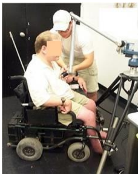
圖 2.3.2 三維空間測量儀 (Three-dimensional Anthropometer) (資料來源：Victor Paquet, 2004)
