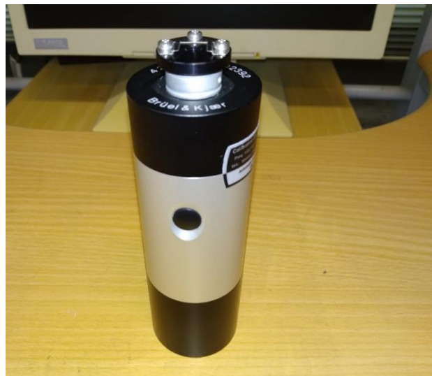
圖 4- 3b&k type 4294 加速規校正器
