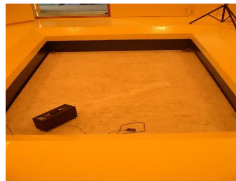
圖 2- 2 性能實驗中心 R2/R3 樓板衝擊音實驗艙及試驗開口
