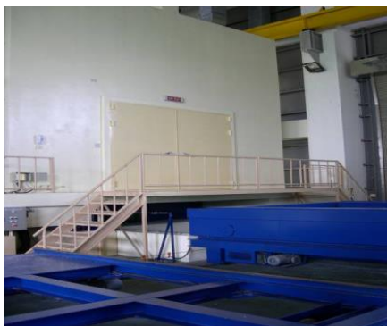
圖 2- 2 性能實驗中心 R2/R3 樓板衝擊音實驗艙及試驗開口
