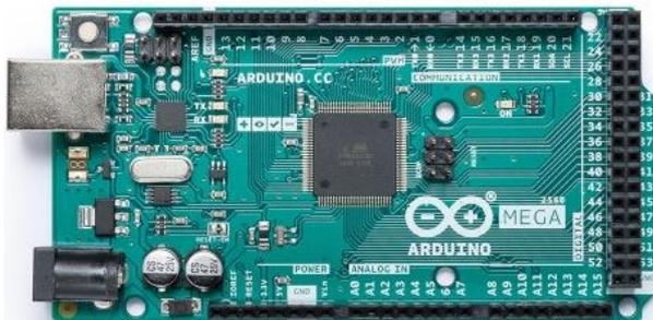
圖 3-1 Arduino Mega 板
