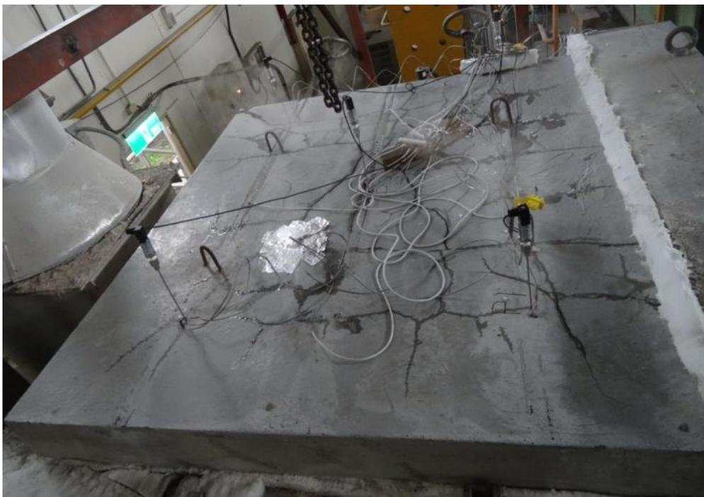
圖 4-19 試體S00 試驗中非曝火面情形
