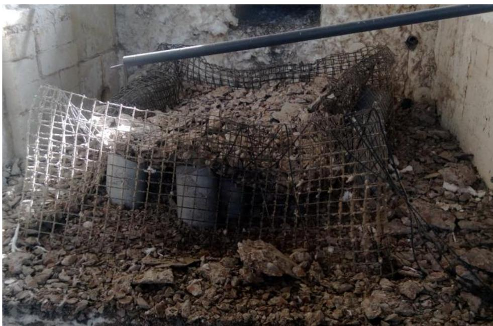
**圖 4-21 試體S00 試驗後，爐內佈滿爆裂剝落的混凝土碎塊**
