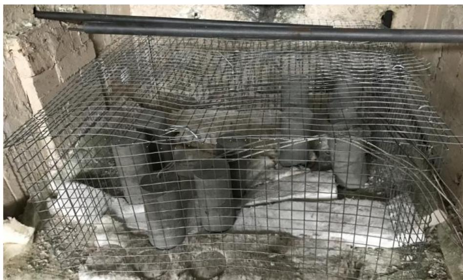
**圖 4-2 試體四周以鐵絲網防止爆裂損壞試驗爐**
