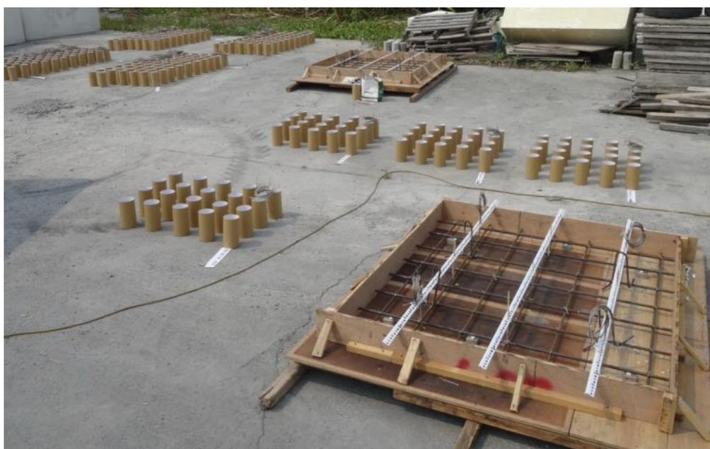
**圖 3-8 試體灌製前場地佈設**
