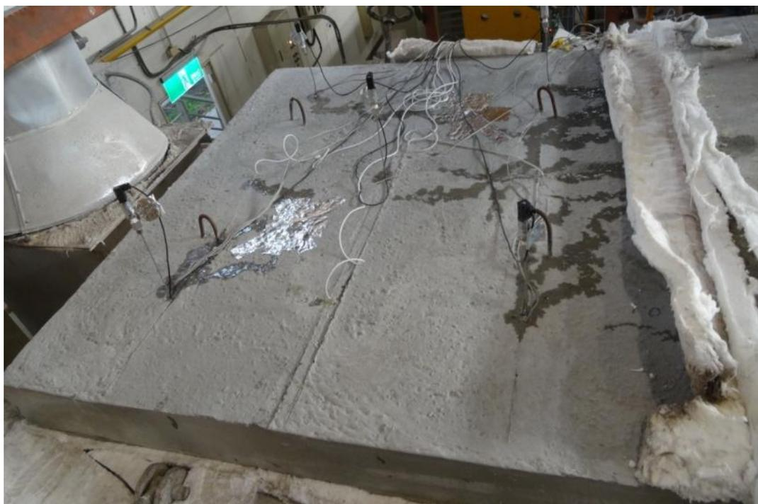
**圖 4-32 試體S10 試驗中非曝火面情形**
