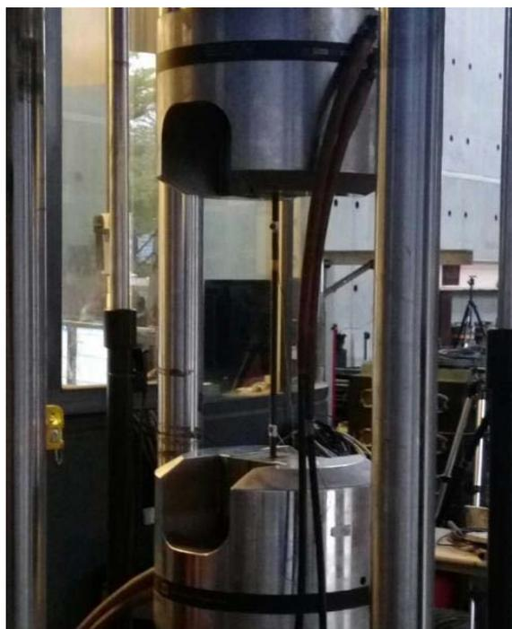
圖 3-3 SD 785 鋼筋拉伸試驗
