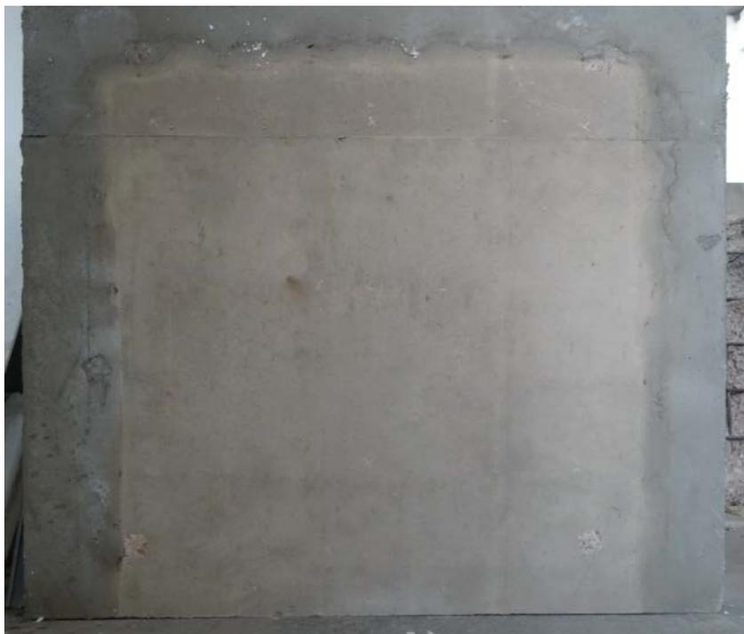
**圖 4-35 試體S10 試驗後曝火面**
