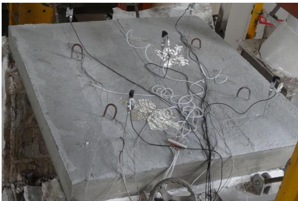
圖 4-30 試體S10 試驗前非曝火面及量測配置
