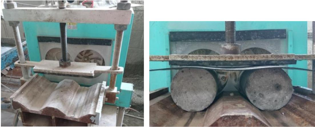
**圖 3-13 抗壓強度圓柱試體端部磨平處理**
