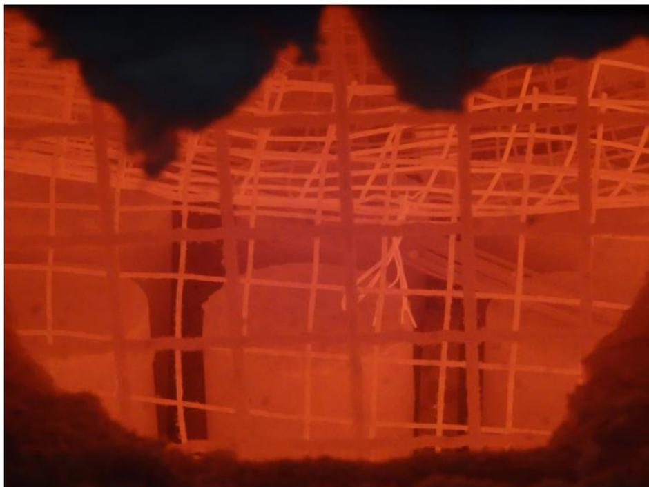
**圖 4-3 圓柱試體加熱過程情形**
