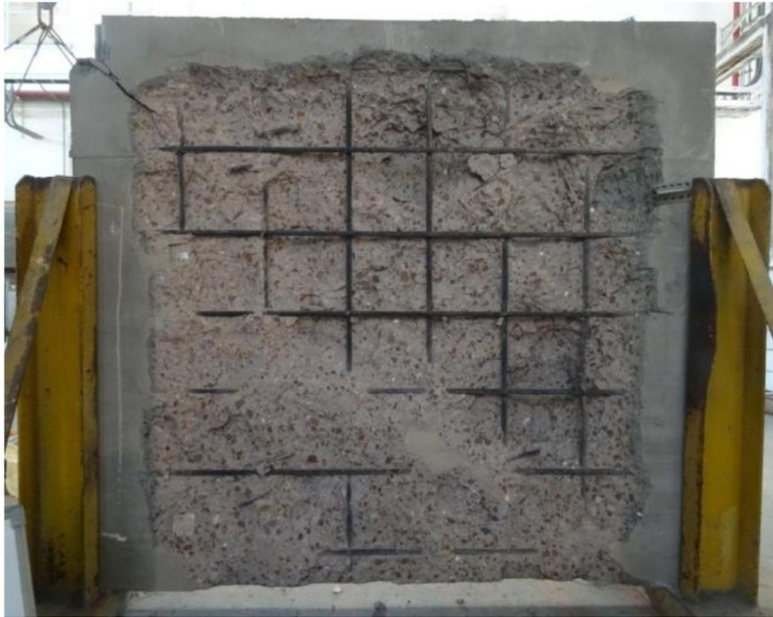
圖 4-23 試體S00 試驗後曝火面
