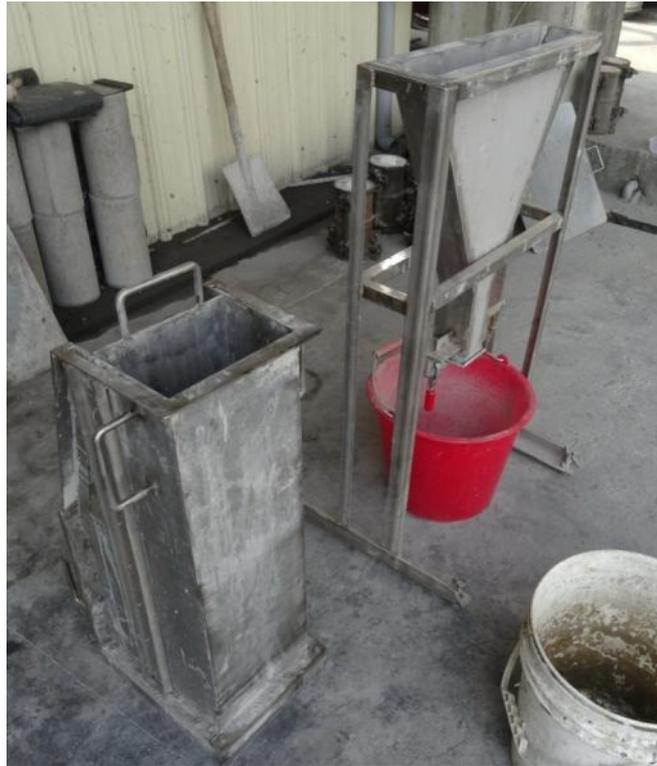
**圖 3-9 新拌混凝土流動性測試儀具（箱型試驗及V漏斗）**
