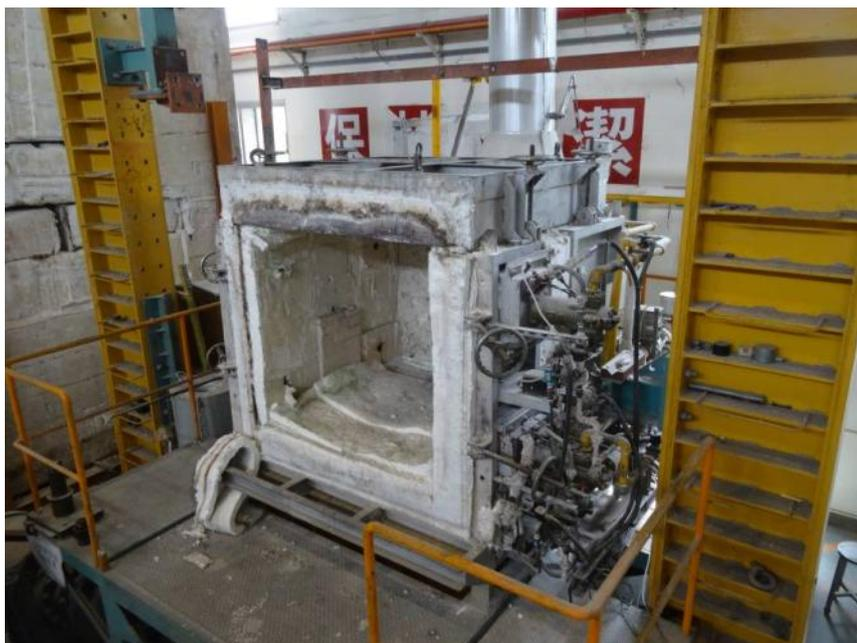
**圖 3-18 小型多功能耐火試驗爐設備圖**
