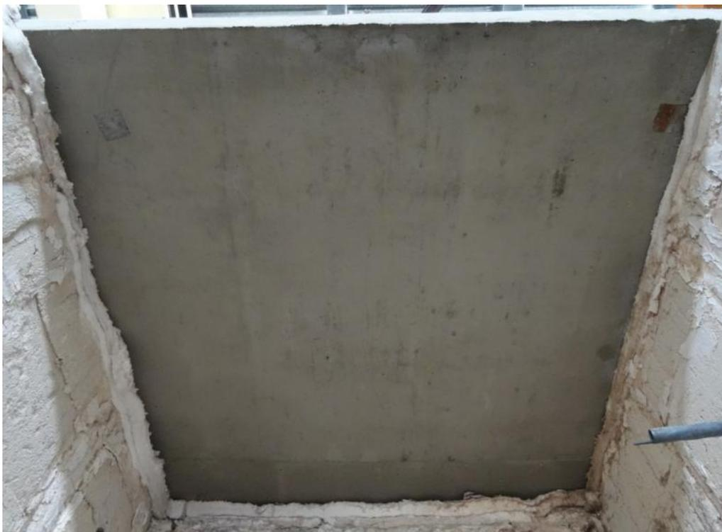
**圖 4-31 試體S10 試驗前曝火面**
