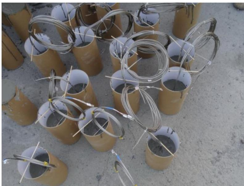
**圖 3-11 圓柱試體製作情形**
