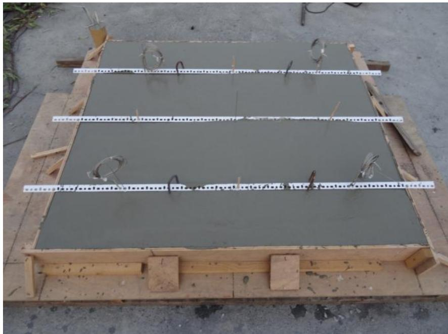
**圖 3-14 板試體製作完成**
