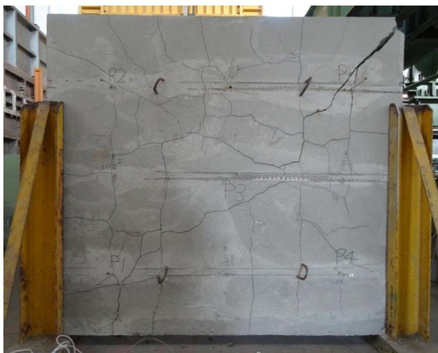
**圖 4-22 試體S00 試驗後非曝火面**
