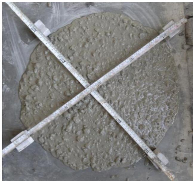
**圖 3-10 新拌混凝土坍流度**
