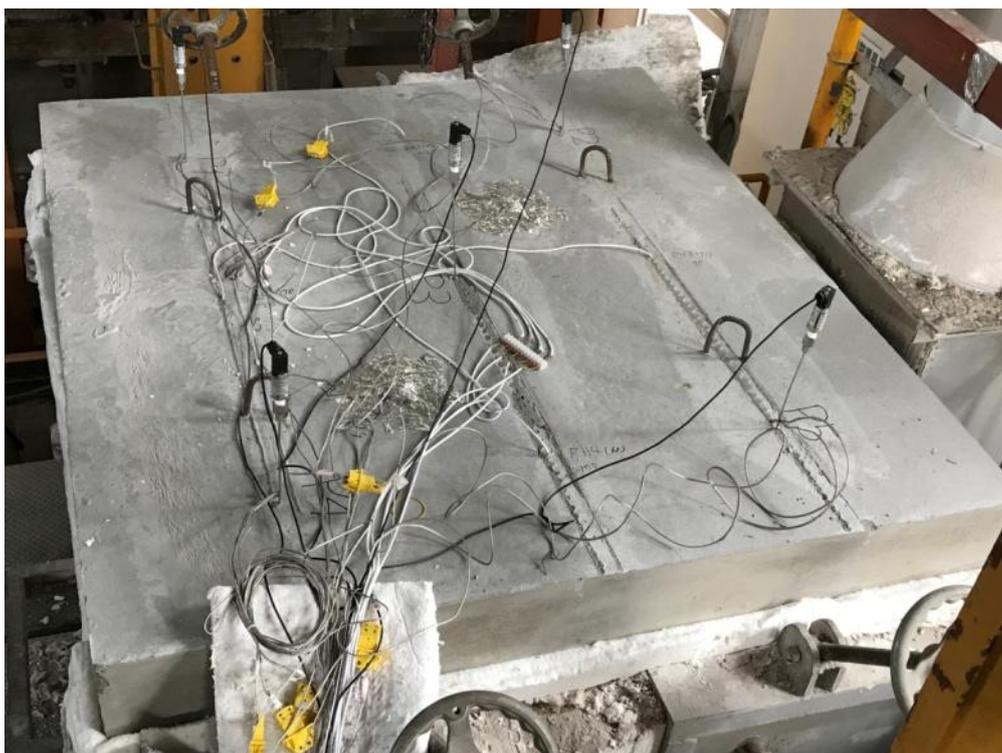
**圖 4-17 試體S00 試驗前非曝火面及量測配置**
