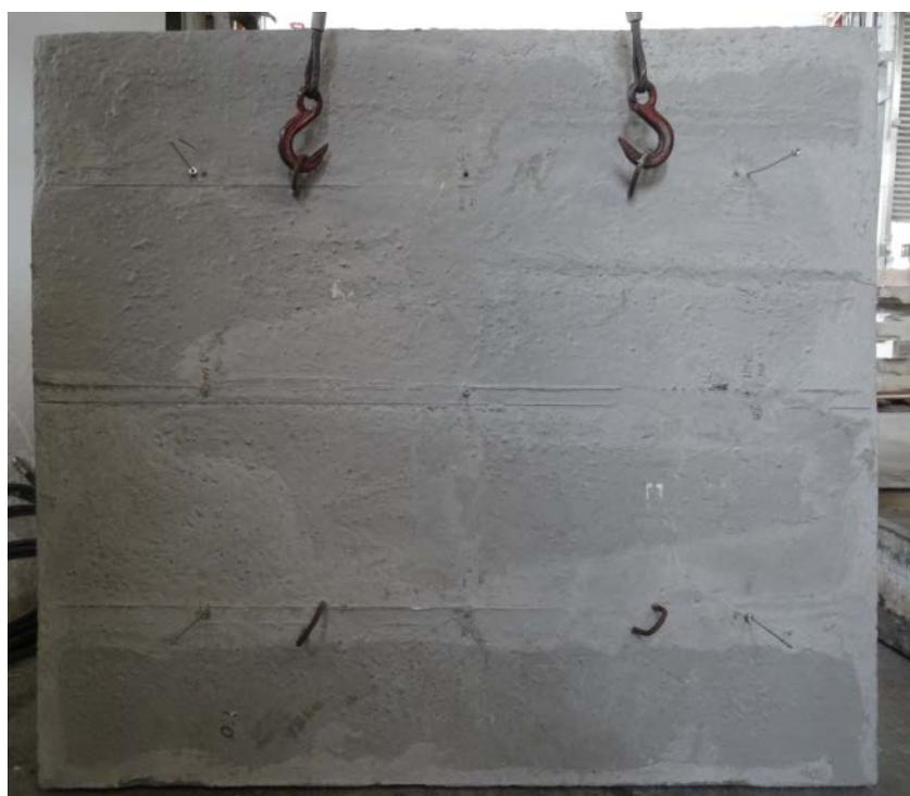
**圖 4-34 試體S10 試驗後非曝火面**
