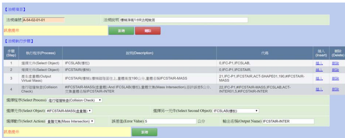
圖 4-5 進行碰撞檢查 (虛量體與樓板進行交集碰撞檢查) (由本研究繪製)
