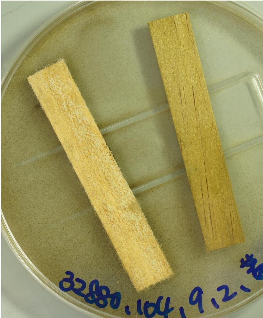
圖 3-14 添加 Tan-AM 180 ppm 之放射松 ACQ 處理試片於 28 天時之生長情形。
