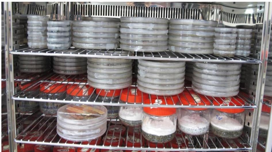
圖 3-10 防黴試驗培養皿置於生長箱中之示意圖。
