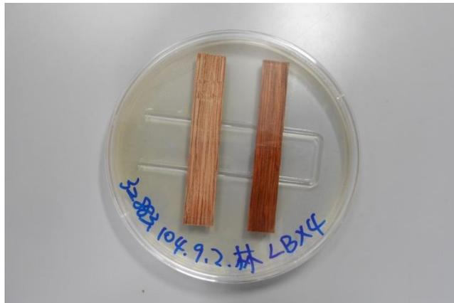
圖 3-9 U 型玻棒與試片於試驗中培養皿置入之示意圖。
