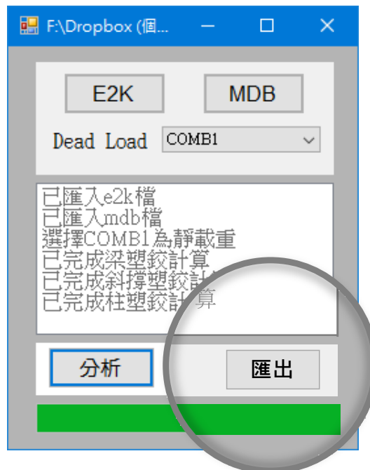
圖 3.15 匯出包含構件塑鉸之 e2k 檔
