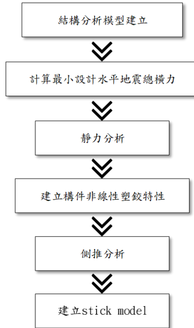
圖 5.5 結構建立 stick model 流程
