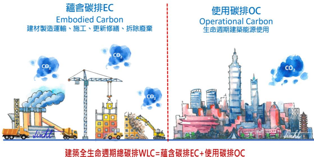
圖 1.4 建築全生命週期碳足跡包含蘊含碳排 EC 與使用碳排 OC(林憲德繪圖)
