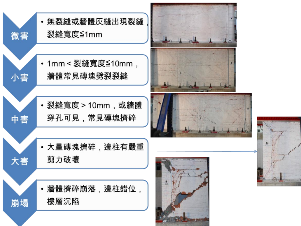
圖 3.8 磚牆損傷判定等級 (資料來源：[24])
