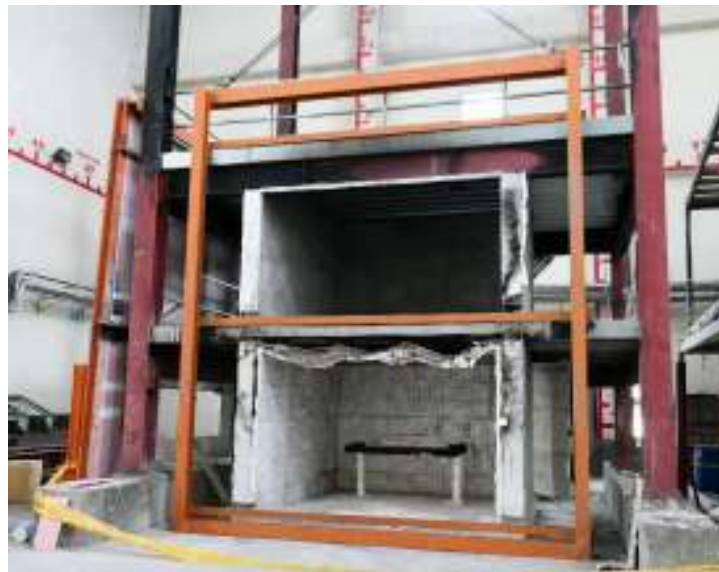
圖 4-3 安裝試體框架至防火試驗屋
