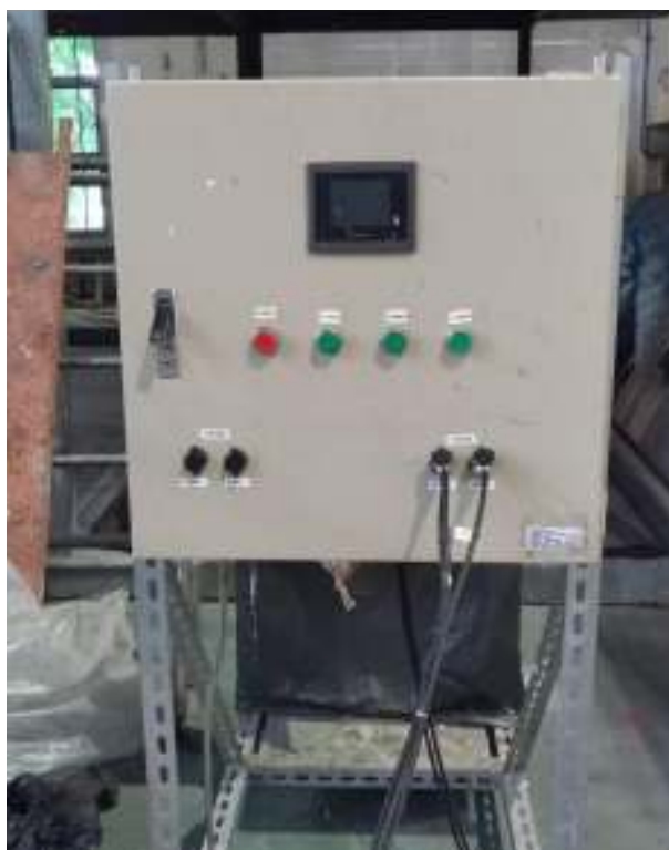
4. 圖為燃燒器之控制面板，可控制室內燃燒器與窗戶燃燒器之流量。
