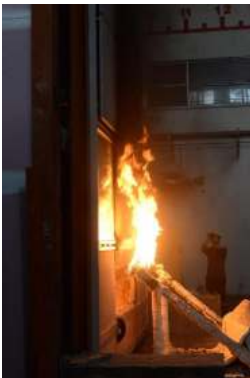
圖 4-20 窗戶燃燒器火焰側視圖
