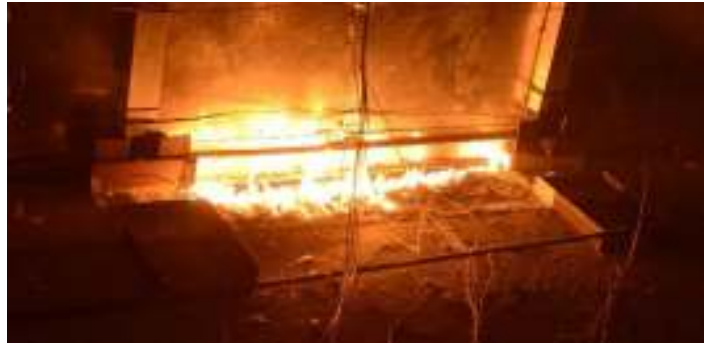
圖 3-52 層間塞非曝火面的阻煙膠引燃現象
