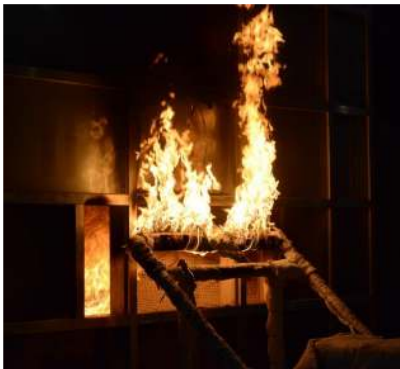
圖 3-44 玻璃碎片掉落於窗戶燃燒器出火口
