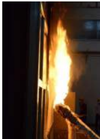
圖 3-43 窗戶燃燒器火焰側視圖
