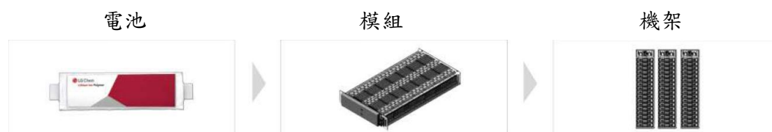
圖 1 鋰離子電池的電池、模組、機架
