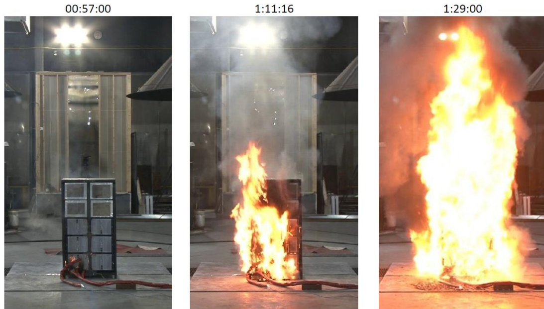
接近點火時間（左），接近預期的撒水操作時間（中），熱釋放率峰值（右）
