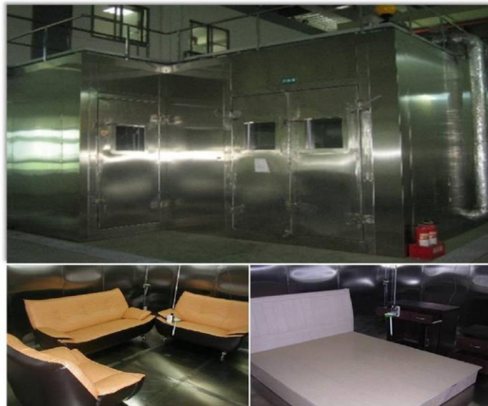
本所性能實驗中心全尺寸建材家具檢測環控艙(林霧霆拍攝)
