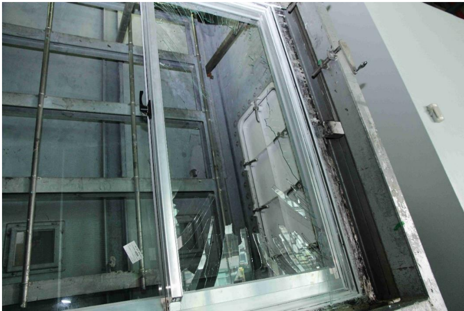
門窗抗風壓性試驗玻璃破裂(蔡宜中攝)
