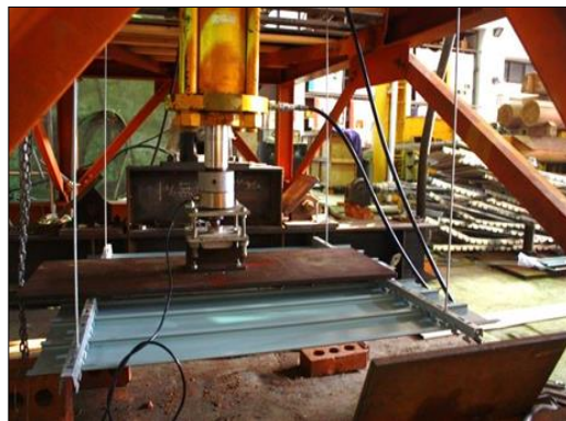
圖 62. 支撐架向下載重試驗
