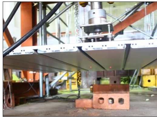
圖 67. 卡麗板向下載重試驗
