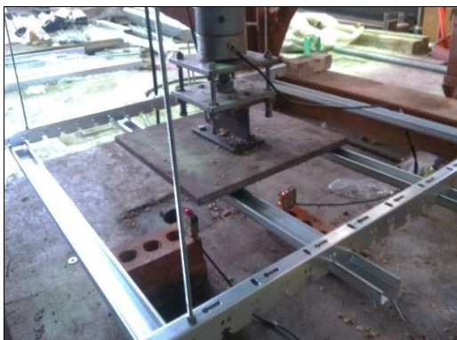
圖 64. 主架向下載重試驗
