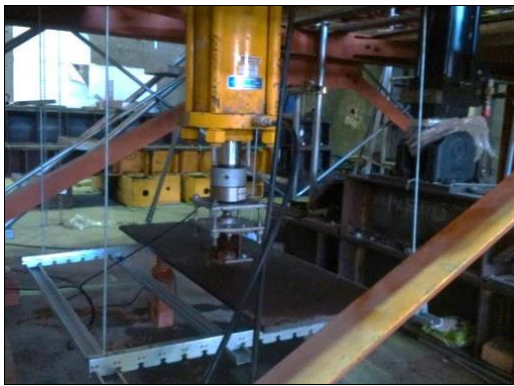
圖 59. 支撐架向下載重試驗
