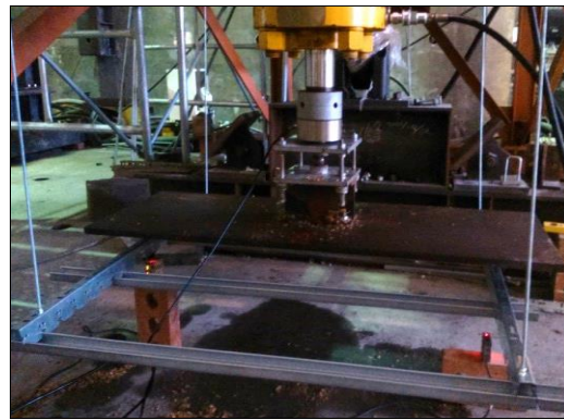
圖 60. 支撐架向下載重試驗
