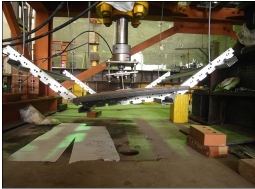
圖 20. 細部元件撓度試驗
