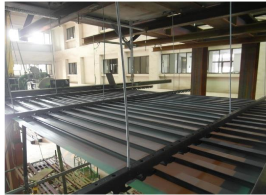
圖 78. T1 沿板材方向施加载重（圖片來源：本研究）
