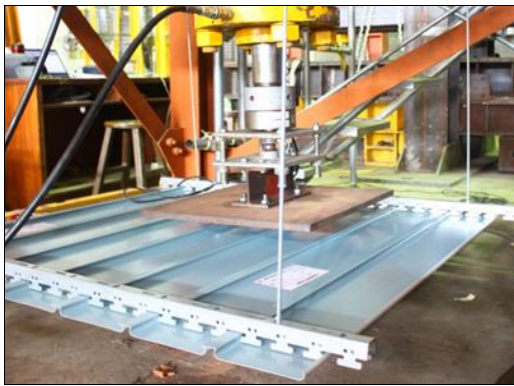
圖 66. 卡麗板向下載重試驗
