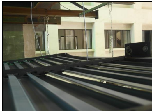
圖 128. T12 支撐架前端挫屈變形
