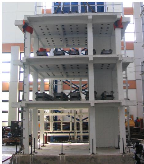
圖 4.32 含非結構牆之 RC 抗彎構架
