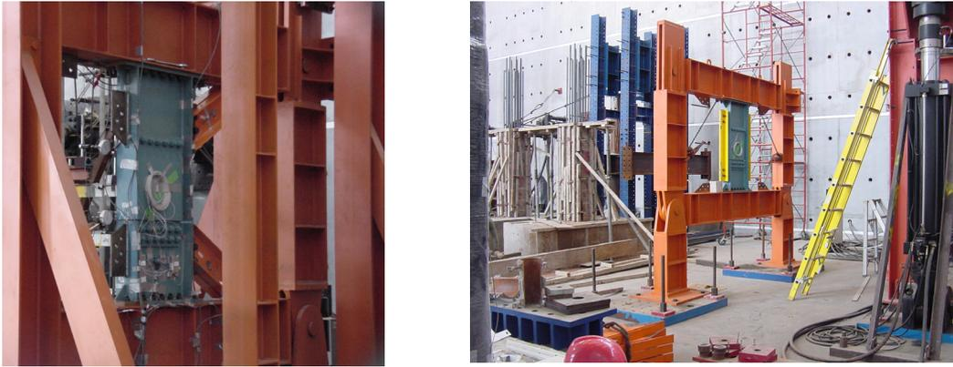
圖 5.12 反覆循環載重試驗裝置圖
