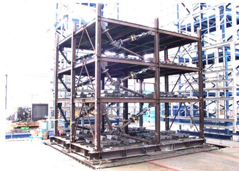
圖 4.25 含黏性阻尼器之上肘型斜撐構架
