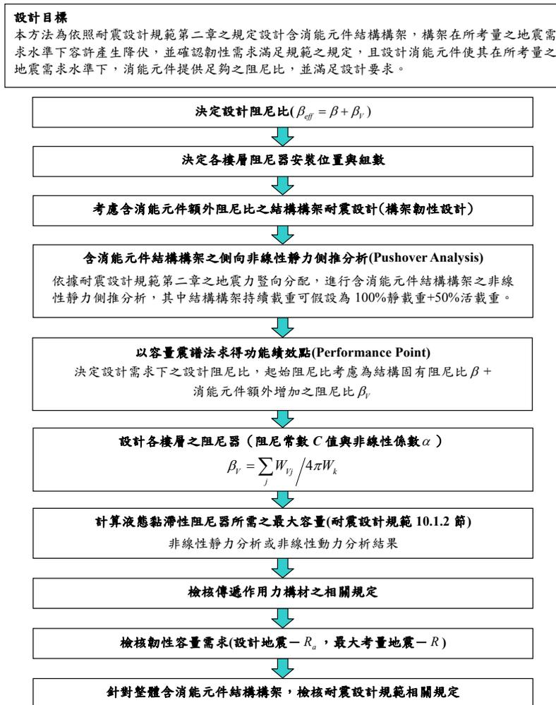
圖 4.20 非線性靜力分析設計—液態黏滯阻尼器
