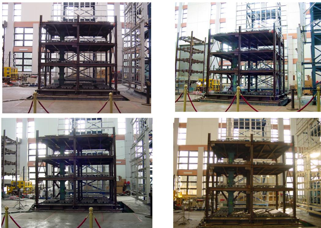
圖 5.14 含阻尼構架之振動台配置
