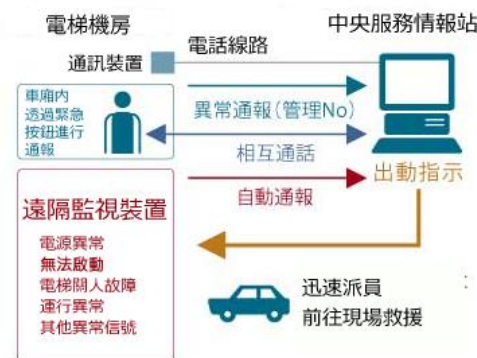
圖 2-10 遠隔監視裝置服務流程[12]
