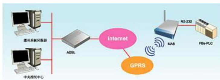
圖 5. GPRS 遠方連線架構
