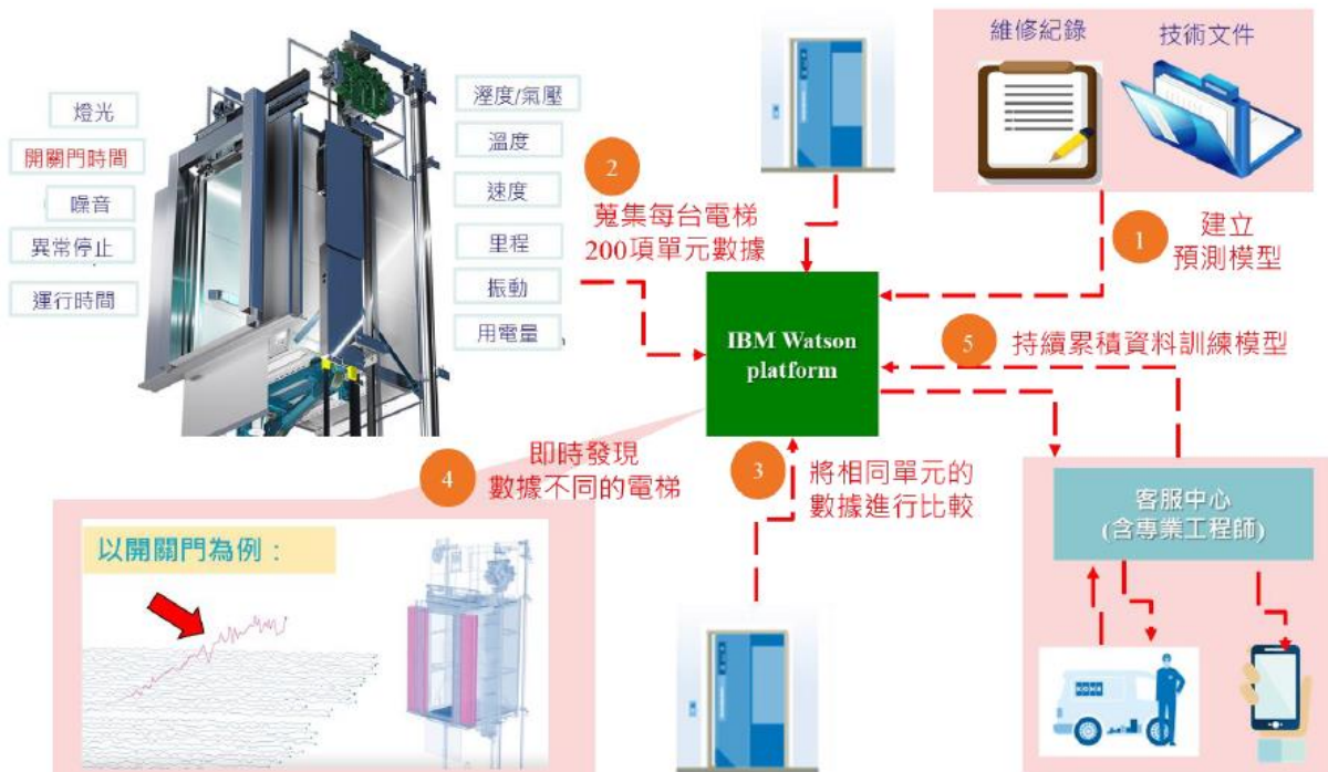
圖 3-9 通力電梯-IBM Watson 物聯網雲平臺運作模式[9]
