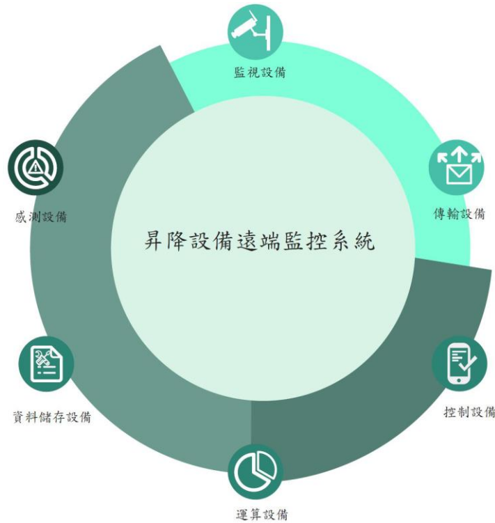
圖 3-1 昇降設備系統架構圖[15]
