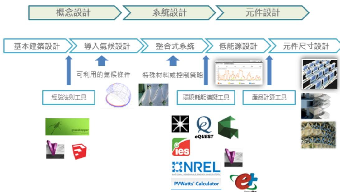
圖 5-1 整合式節能外牆之設計流程
