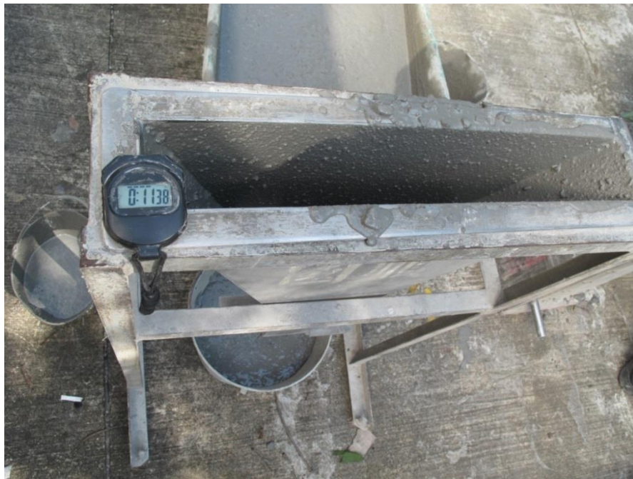
照片 2.13 混凝土留下漏斗時間 (資料來源：本研究製作)
