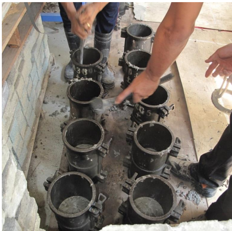
照片 2.14 混凝土圓柱試體灌漿作業 (資料來源：本研究製作)
