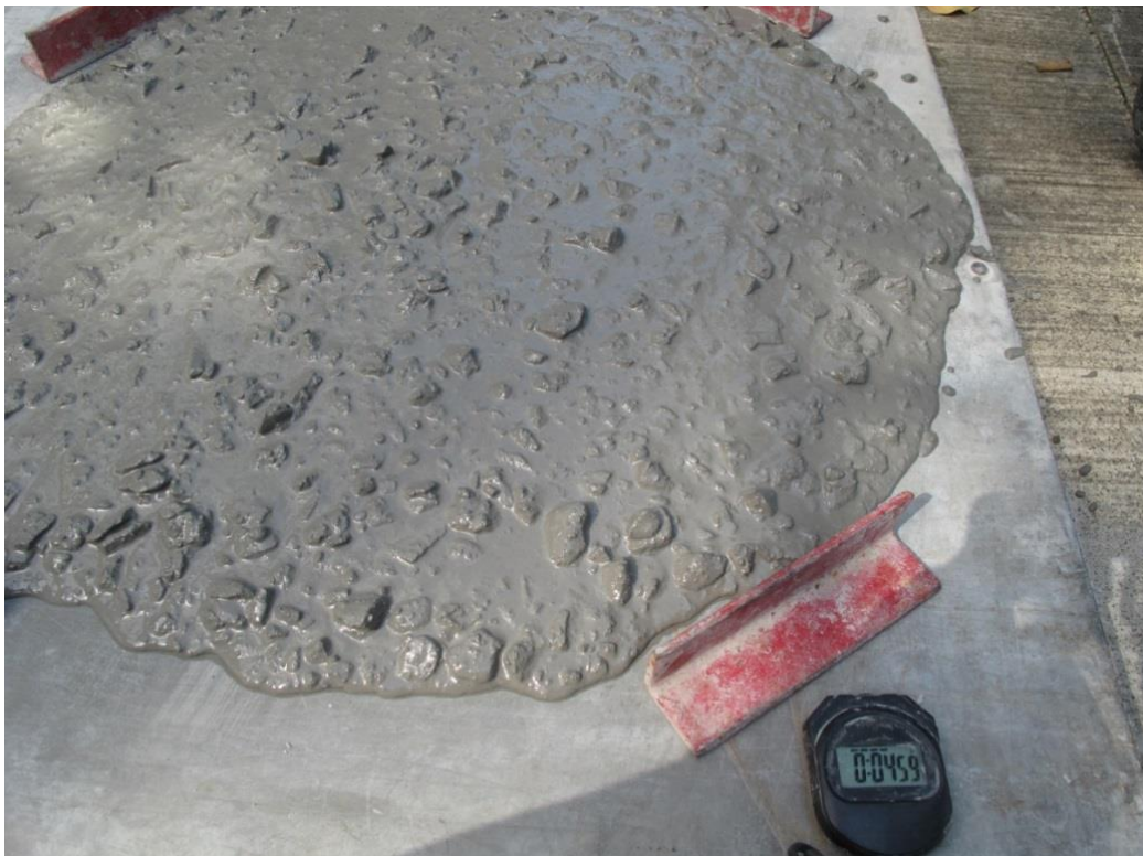
照片 2.12 混凝土坍流度示意圖 (資料來源：本研究製作)
