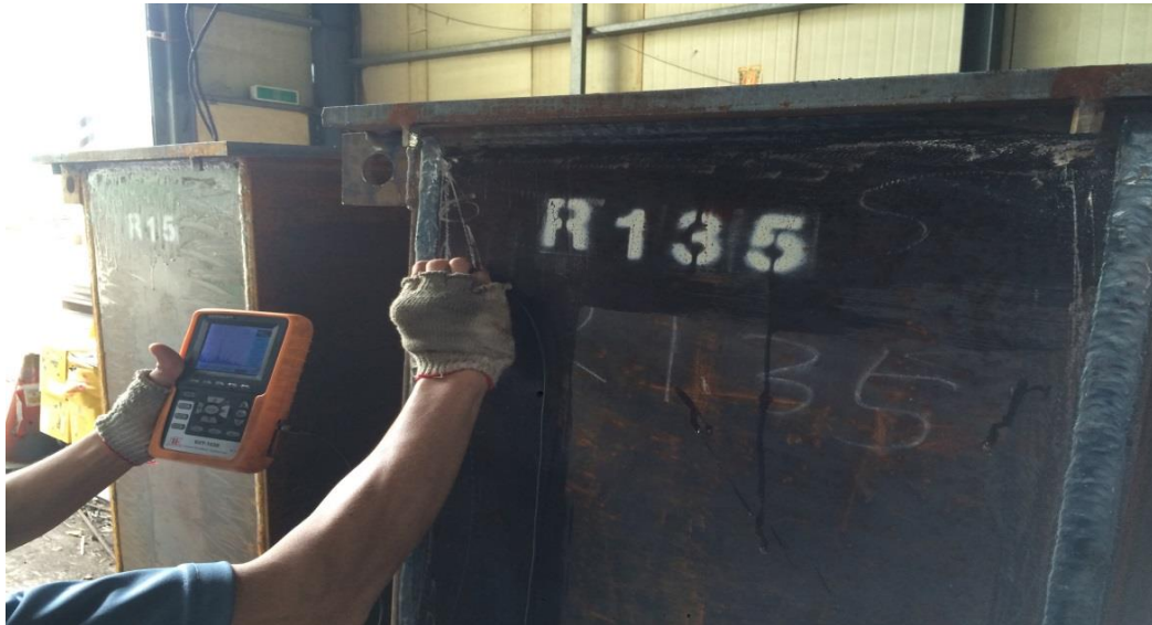
照片 2.4 銲道超音波檢驗 (資料來源：本研究製作)
