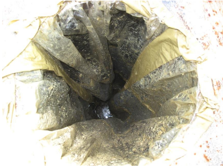
照片 2.7 IR 系列試體內側置入塑膠袋示意圖 (資料來源：本研究製作)
