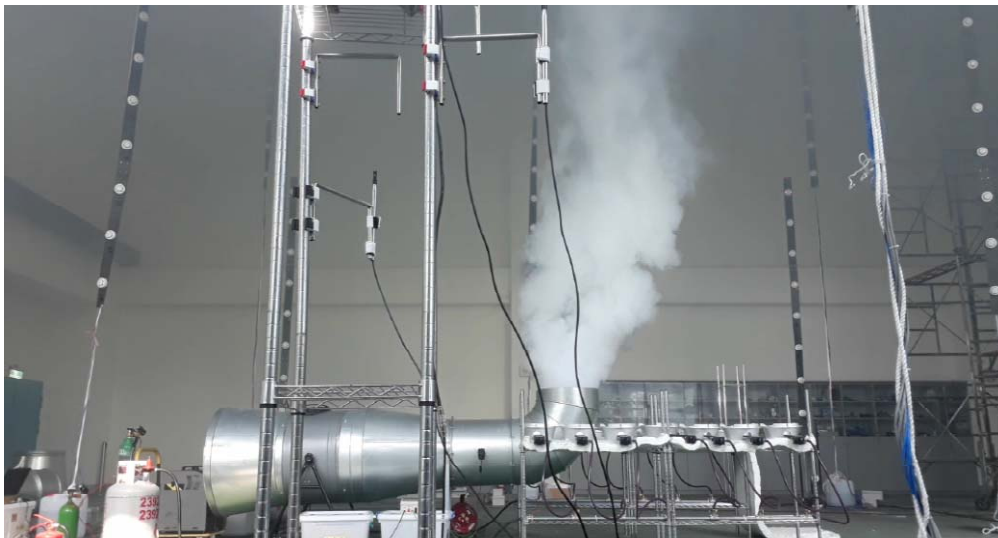
圖 3-11 熱煙測試可控煙流率與密度造煙系統
