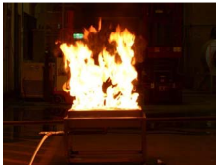
圖 3-7 延燒試驗設備
