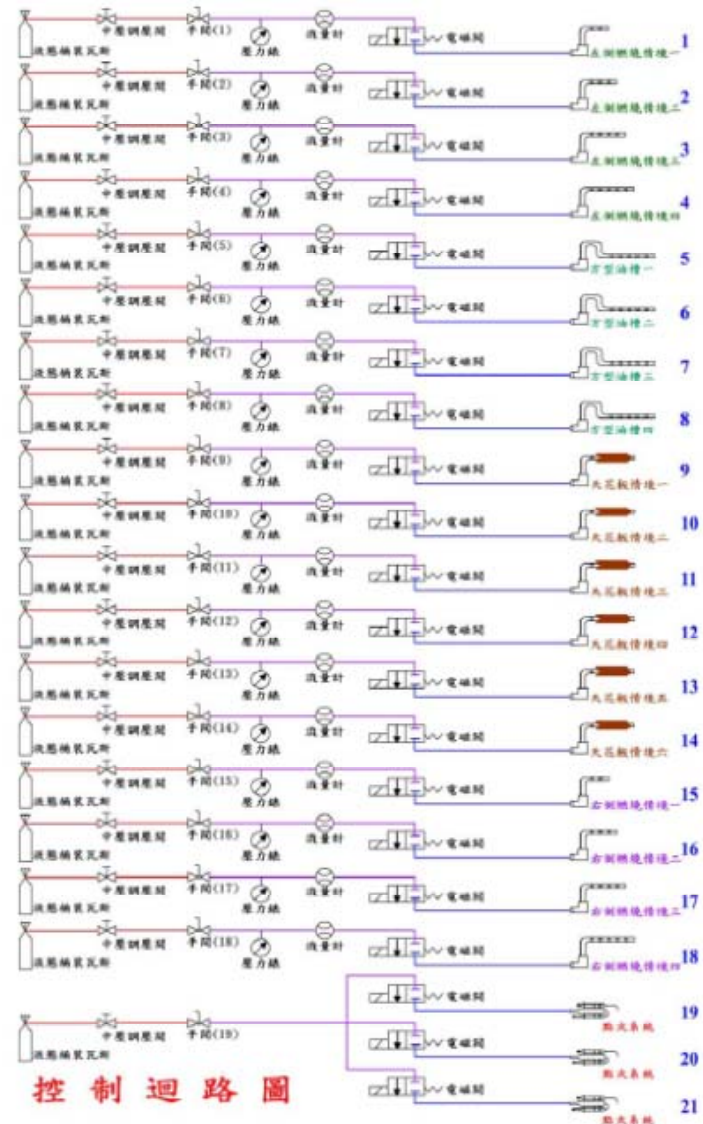
圖 2-41 貨櫃型式火災模擬器控制迴路圖
