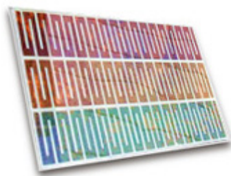
圖 2-13 染料敏化太陽能電池
