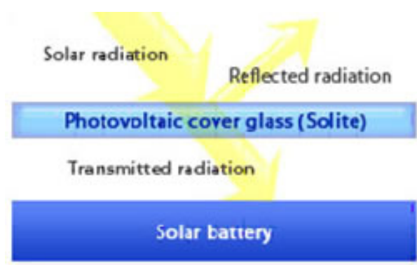
圖 2-18 特製的強化玻璃統
