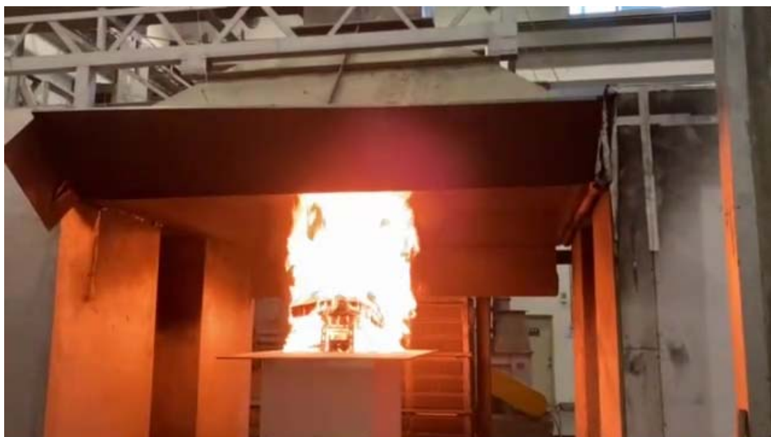
圖 3-11 模擬傢俱燃燒試驗圖
