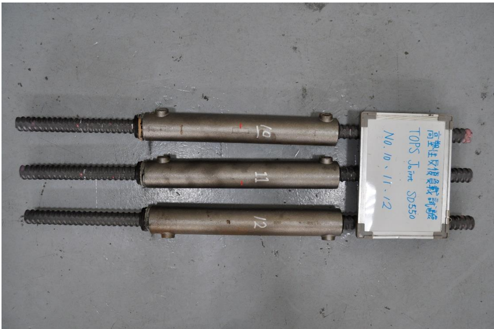
圖 3-24 SD550 D38 鋼筋續接套管破壞模式-拔出 (資料來源：本研究製作)
