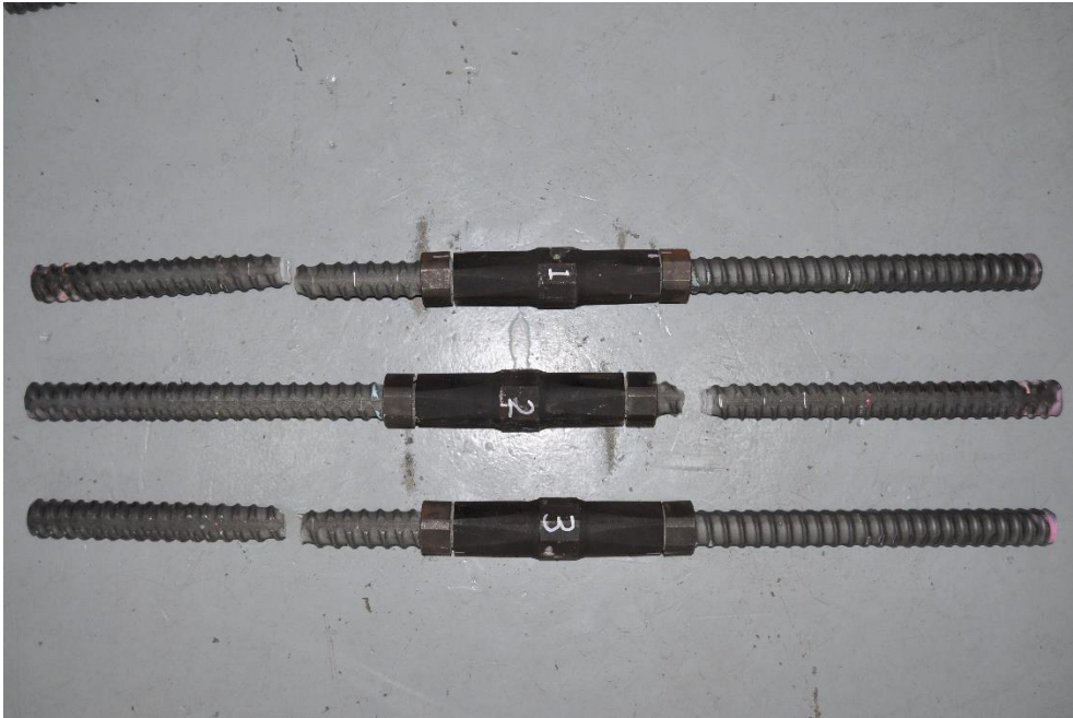
圖 3-23 SD550 D38 螺紋節鋼筋續接組件破壞模式-斷筋 (資料來源：本研究製作)
