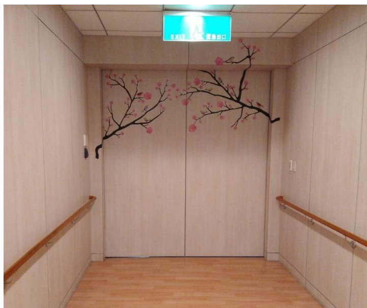
圖 三-35 出入口顏色與牆面相同並加圖騰裝飾，以避免失智者進出 (資料來源：本研究團隊拍攝)
