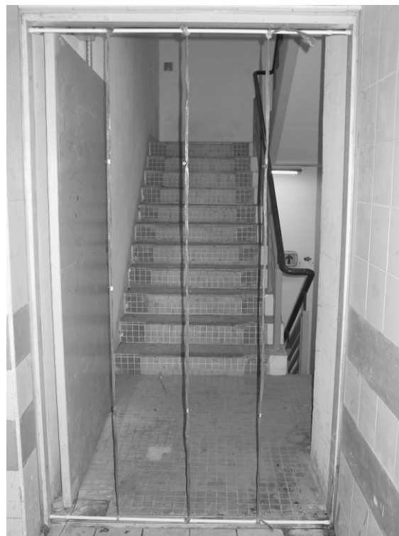
圖 8.8 完成架設風速量測，一門作 16 量測點
