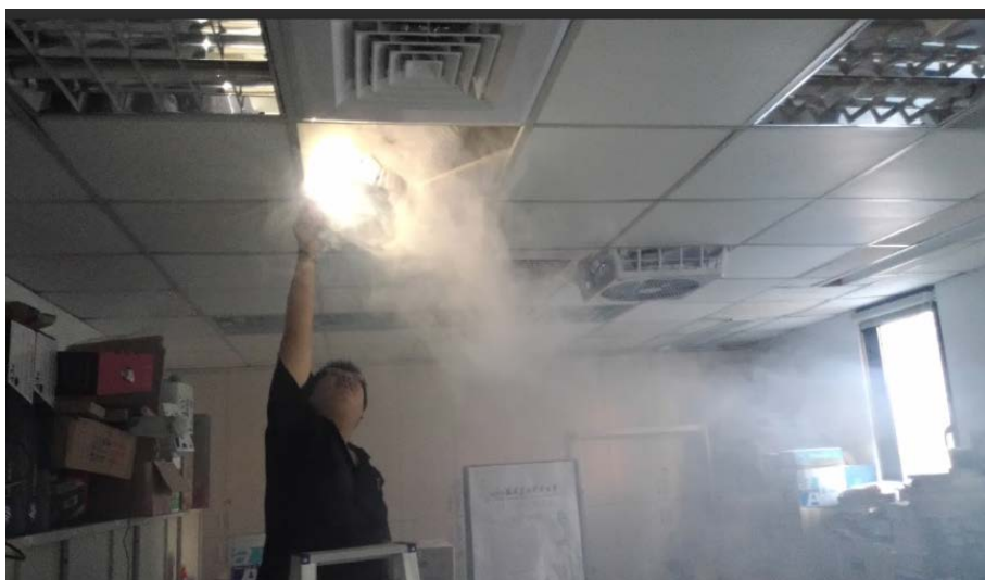
圖 5.29 煙塵經由天花板上方空間水平擴散到隔壁倉庫
