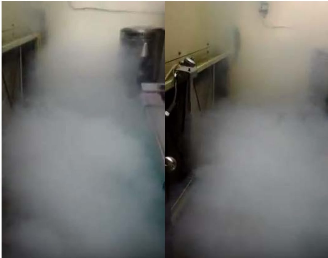
圖 5.30 煙塵被空調風機吸入
