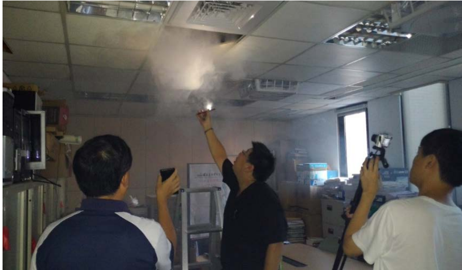
圖 5.27 煙塵經由天花板上方空間水平擴散到隔壁倉庫
