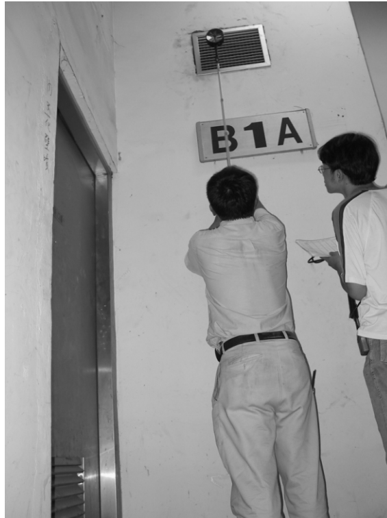
圖 8.9 以 vane 式風量計測量加壓送風量
