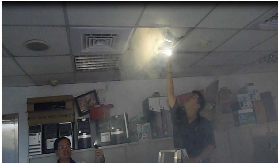
圖 5.28 煙塵經由天花板上方空間水平擴散到隔壁倉庫
