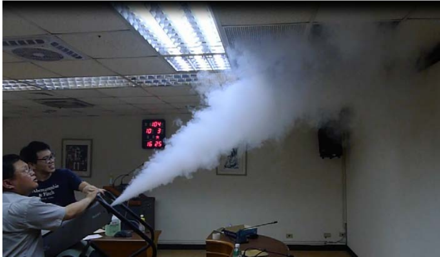
圖 5.25 煙塵進入會議室天花板上方空間
