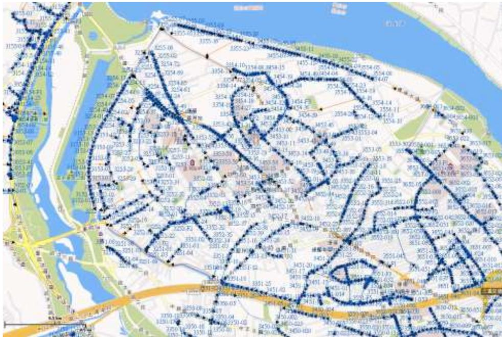
圖 4-3 蘆洲區雨水下水道排水方向圖
