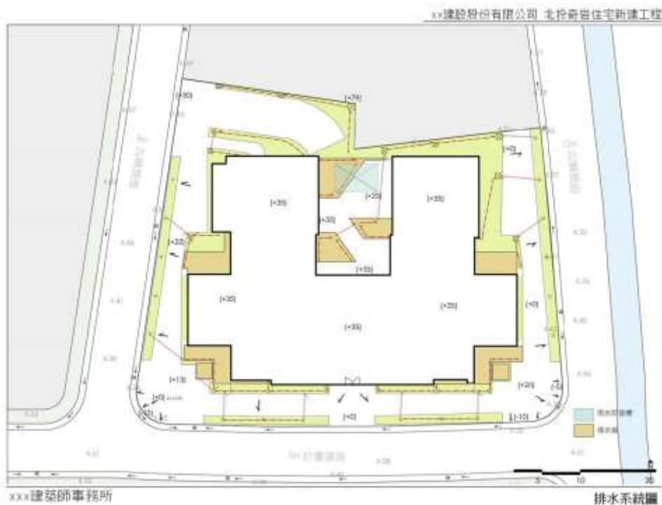
圖 32 雨水排水系統圖二
