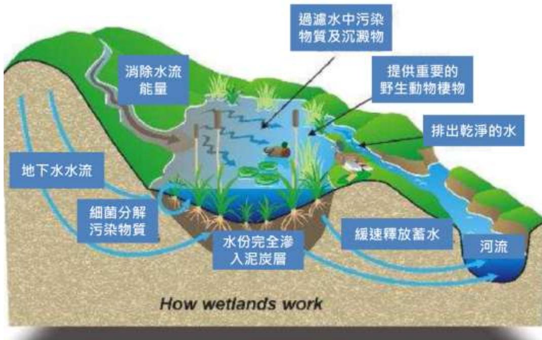
圖 2-11 自然濕地貯存和緩慢釋放雨水過程示意圖
