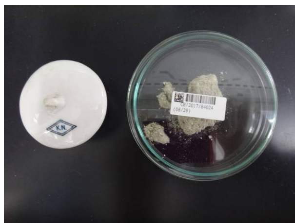
圖 3-12 取樣 (試體研磨後放置瓷器中)
