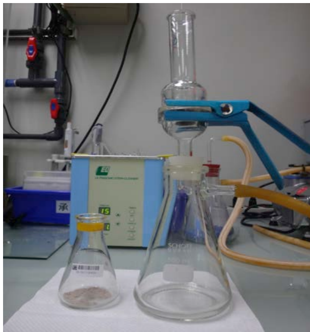
圖 3-13 試體酸處理 (以 450°C 灰化處理後進行酸處理)
