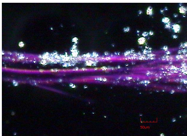
圖 3-17 試體 A (石綿瓦) 偏光顯微鏡下照片(平行)
