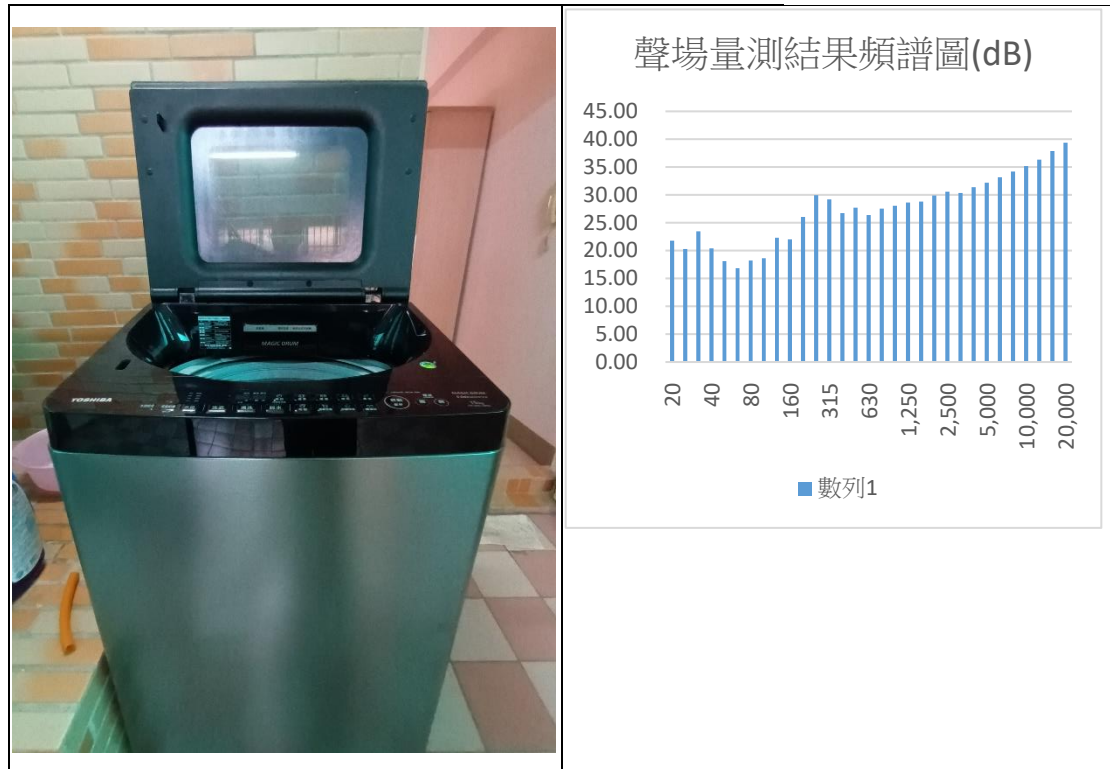
圖 5- 14 洗衣機-脫水行程及其聲音頻譜量測結果
