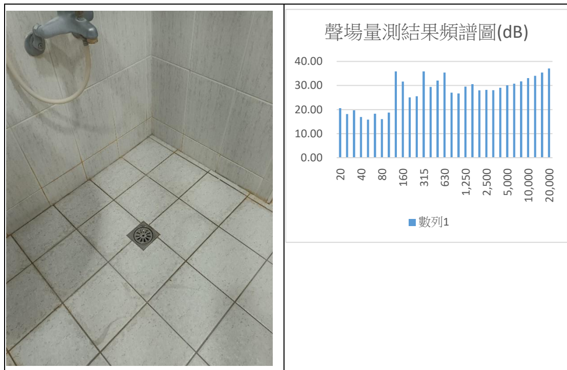
圖 5- 18 管路排水噪音及其聲音頻譜量測結果 (資料來源: 本研究整理)
