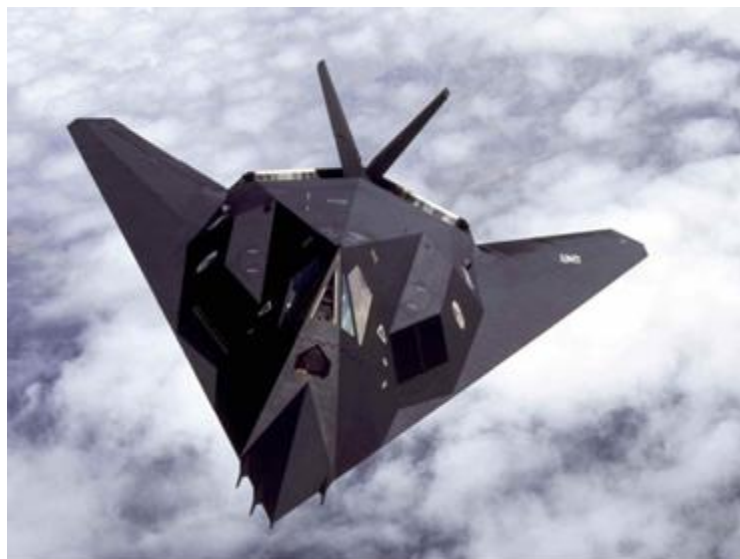
F-117 用陶瓷基材料研製了吸波材料和吸波結構
