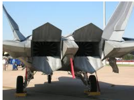
YF-22 猛禽戰鬥機推力噴管也採用陶瓷基複合材料
