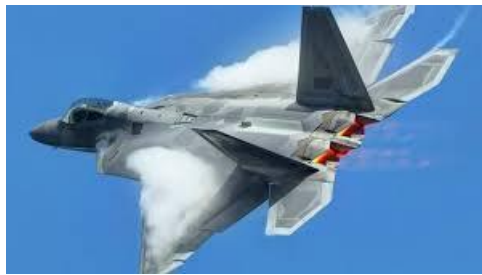
YF-22 猛禽戰鬥機推力噴管也採用陶瓷基複合材料
