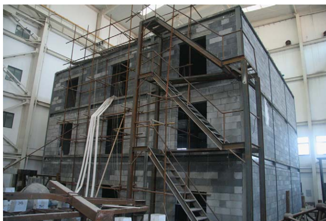
圖 2.13 3層樓鋼結構實驗屋(參考書目[62])
