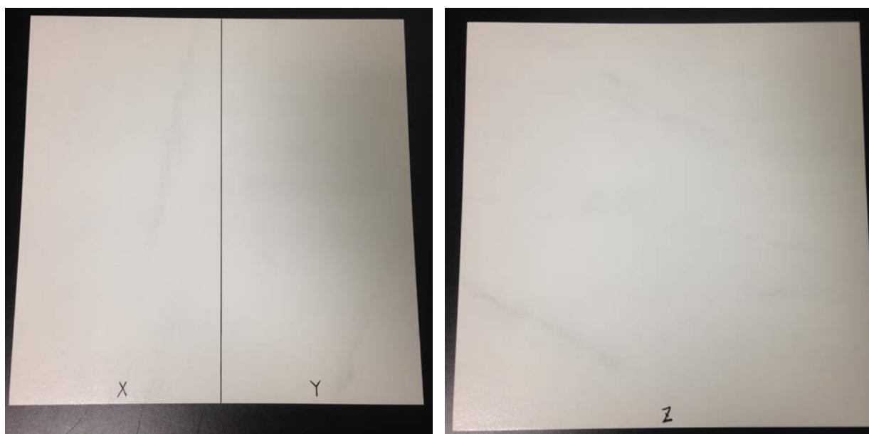
圖 4-3 塗布浴室磁磚地面防滑劑(X)、磁磚地面專用防滑劑(Y)及防滑塗料(Z)
