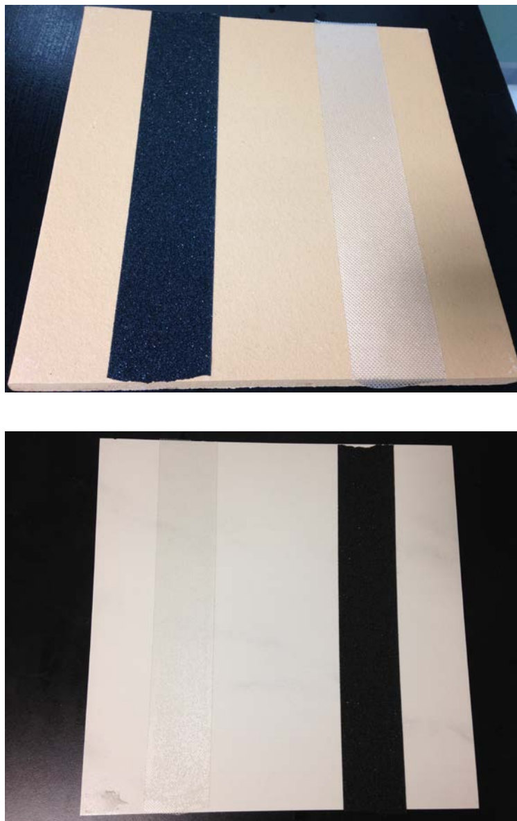
圖 4-1 試體黏貼黑色金鋼砂防滑條及透明浴室防滑條示意圖
