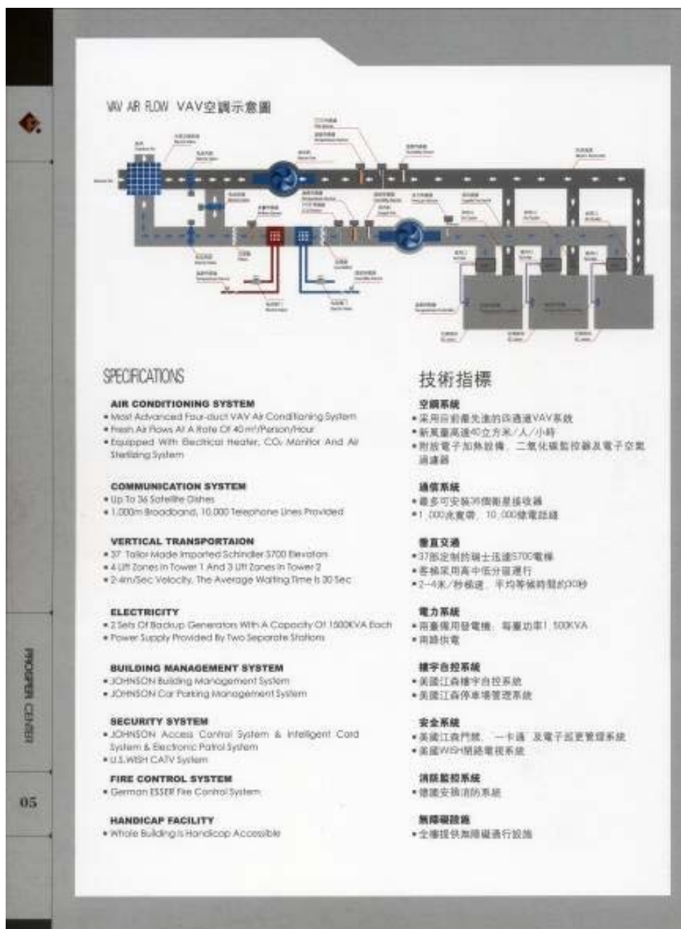
圖 4-88 北京世紀財富中心建築節能設備列表與 VAV 空調系統示意
