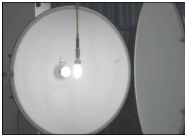
圖 3-1.10 點亮標準燈 20 分鐘以上 (資料來源：內政部建築研究所，2006)
