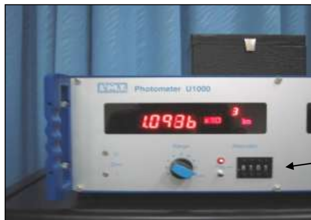
圖 3-1.11 調整衰減器電位計 (資料來源：內政部建築研究所，2006)
