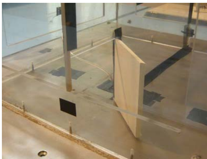
圖 5.6 室內隔間模型裝上門之示意圖與影像圖 資料來源：本研究整理
