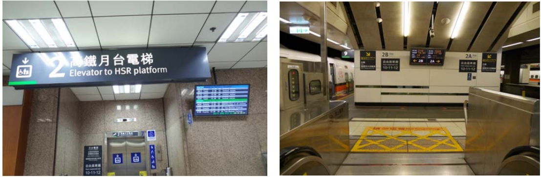
圖4-11 電梯、手扶梯出入口應有明亮照明
