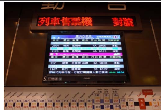
圖3-7LED顯示器設置方式、字體、顏色不易閱讀
