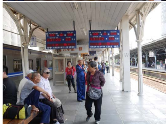
圖3-59 LED 顯示器底板與字體顏色搭配不佳
