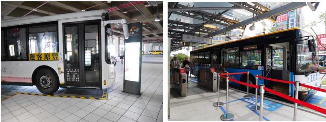
圖4-34應設置與低底盤公車齊平之公車月台
