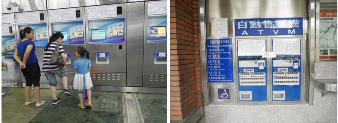
圖4-30自動售票機設置高度應考量不同使用族群
