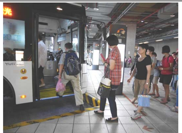
圖3-44公車上車月台未能齊平低底盤公車
