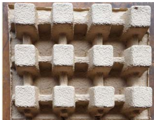
圖 4.2 方型孔透水現場澆置鋪面
