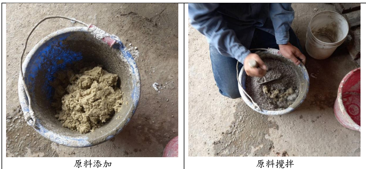
圖2-29 添加5%岩棉之高壓凝土地磚產製作業
