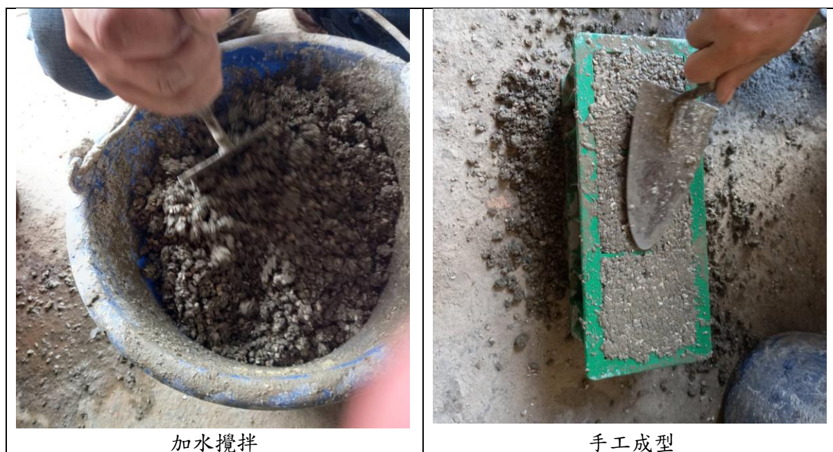
圖2-30 添加10%岩棉之高壓混凝土磚產製作業
