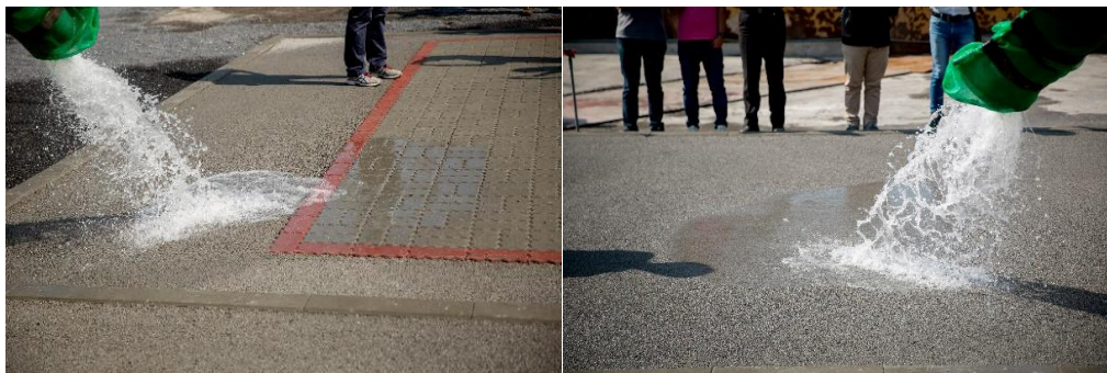
圖 2-13 再生粒料之透水鋪面
