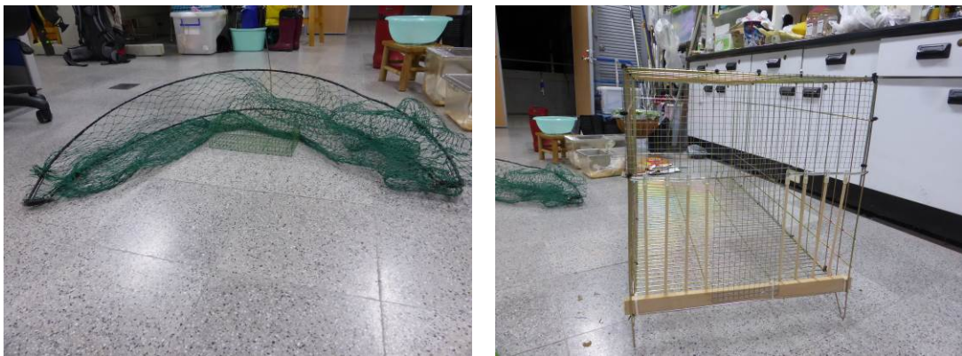
圖 3- 5. 捕捉巨嘴鵝所使用的陷阱。左圖：弓網 (bow net)、右圖：自行設計的走入式陷阱。
