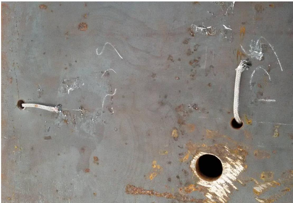
**圖 3-7 外側鋼材熱電偶之安裝**
