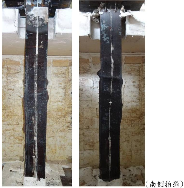
**圖 4-4 試體加熱後情形 (左:EC0; 右:EC50)**
