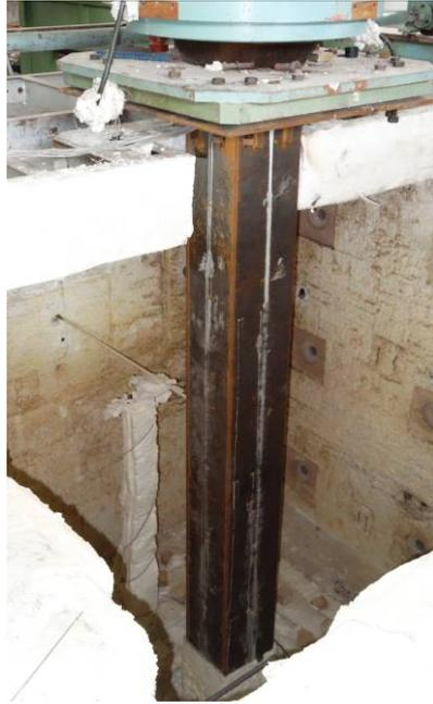
**圖 4-2 試體安裝情形**
