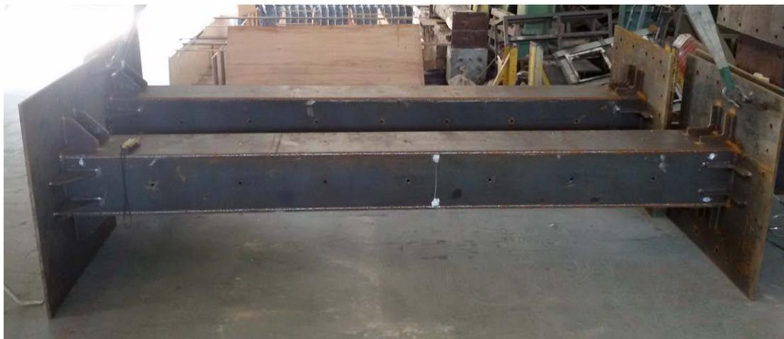
**圖 3-5 鋼柱試體外觀**
