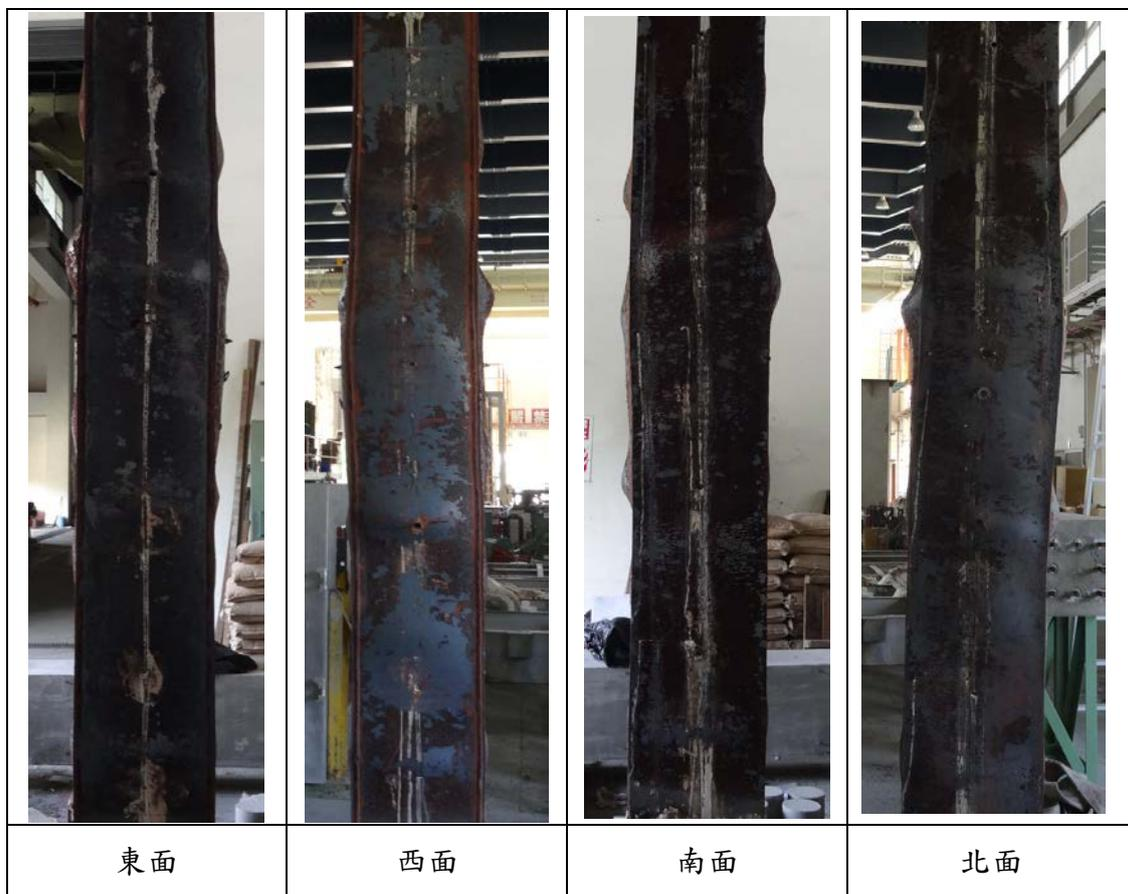
圖 4-19 EC0 試體試驗後外觀
