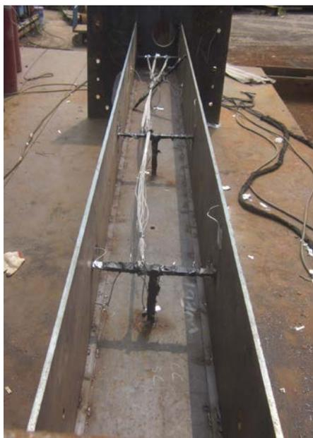
**圖 4-21 試體測溫線配置**
