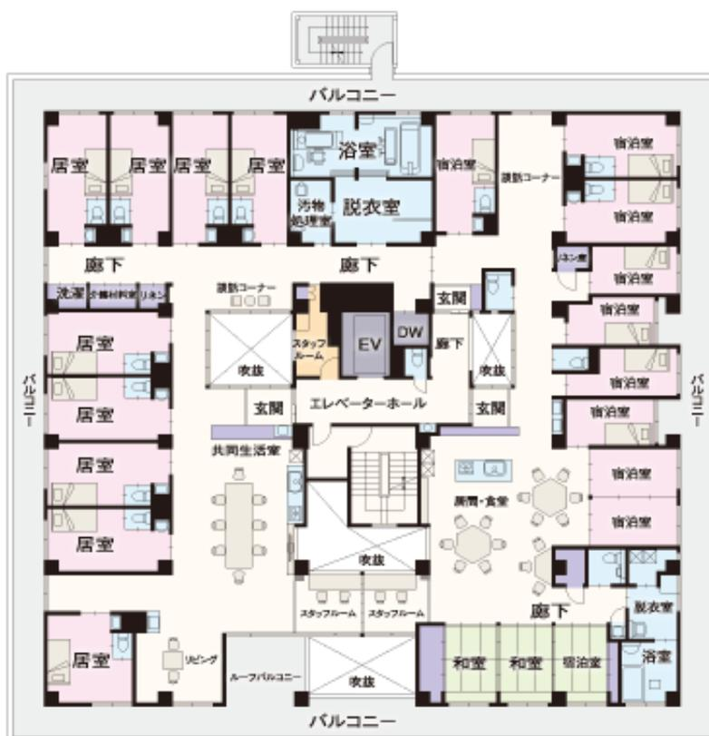
圖 7-19：4F 平面圖，小規模特別養護老人院，共 9 室；小規模多機能日照，喘息住宿
