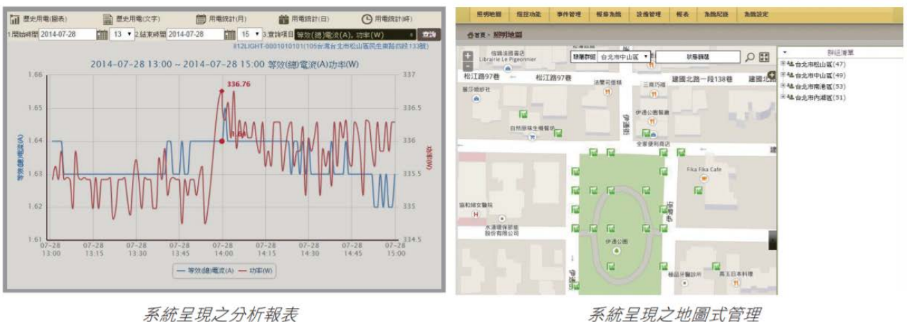
附圖 1.21 工研院 In-Light 智慧照明管理系統管理報表
