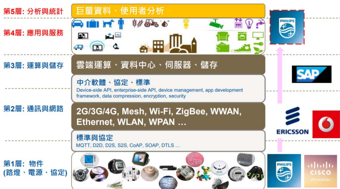
圖 2.7 Philips 智慧道路照明解決方案架構
