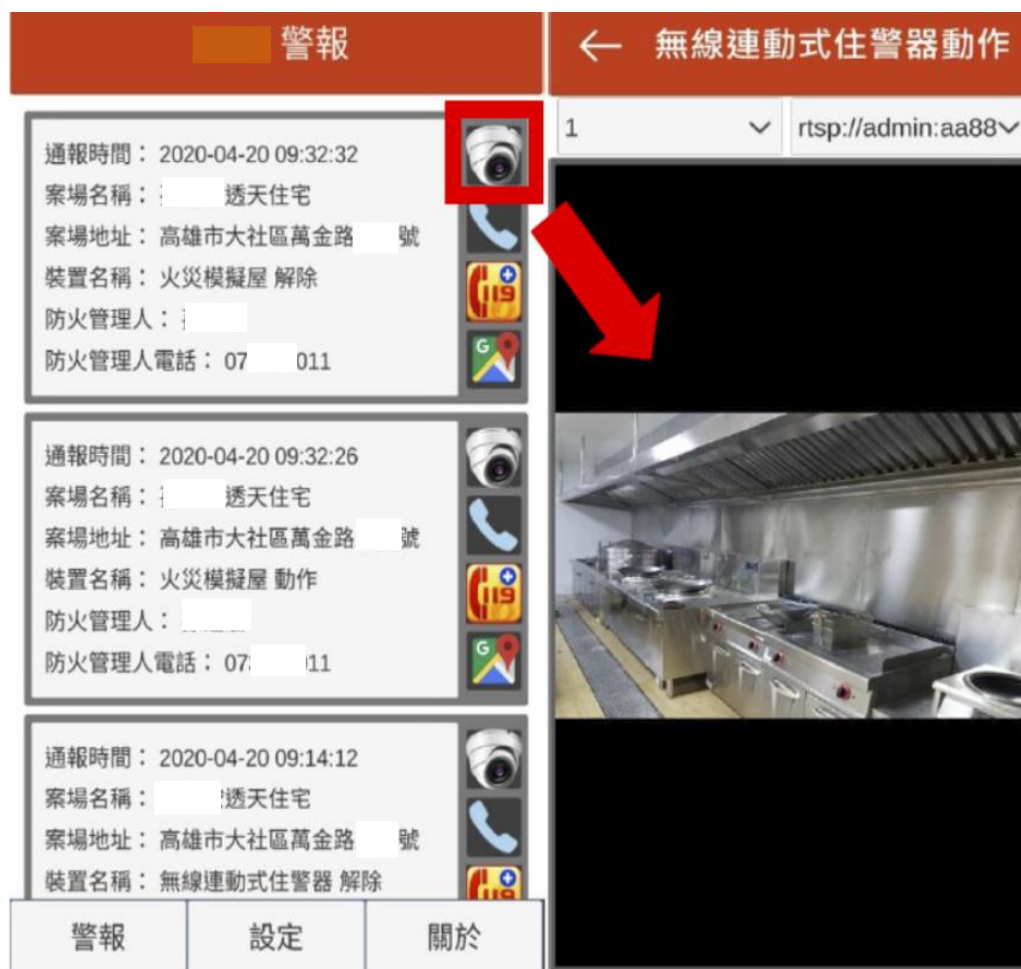
圖 4-12 火警動作即時攝影系統手機 APP 介面示意圖
