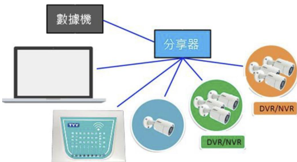
圖 4-11 火警動作即時攝影系統示意圖
